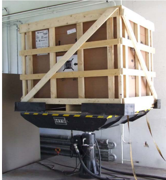
14.a ábra. Csomagolt termék rázóvizsgálata szélessávú véletlen gerjesztéssel hidraulikus rázóasztalon
