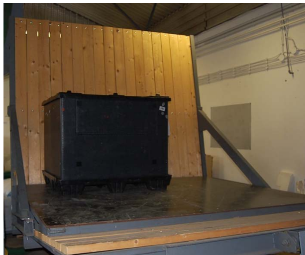
15. ábra. Vízszintes ütésvizsgálat lejtőpályás ütköztető berendezésen
