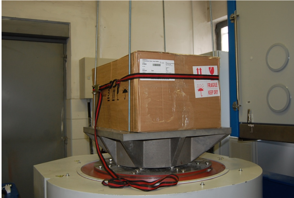
24. ábra. Ütési igénybevétel szimulálása TIRA típusú ütészállóság-vizsgáló berendezésen
