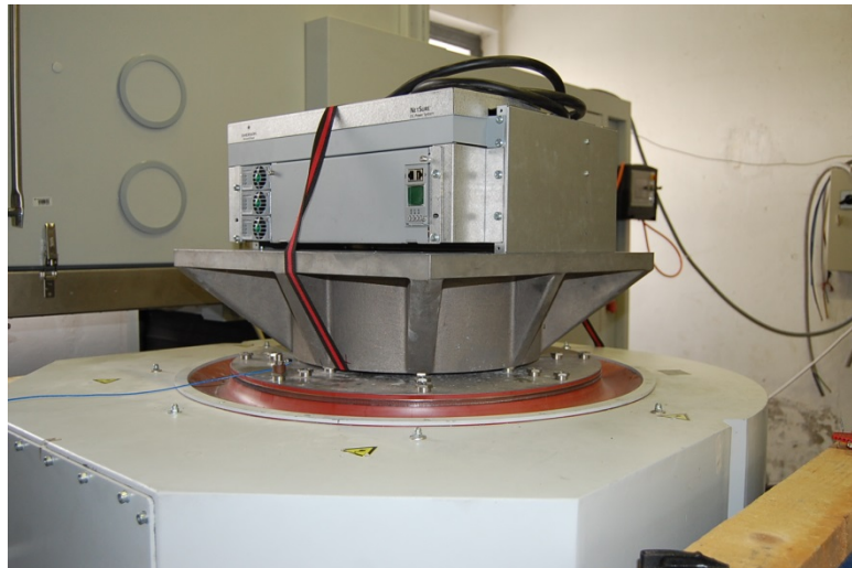
14.b ábra. Csomagolatlan termék rázóvizsgálata rezonancifrekvencia pásztázása elektrodinamikus rázóasztalon
