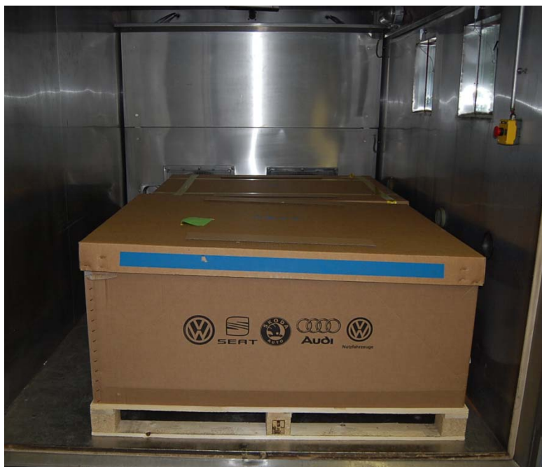
17. ábra. Klímaállósági vizsgálat szállítási csomagoláson
