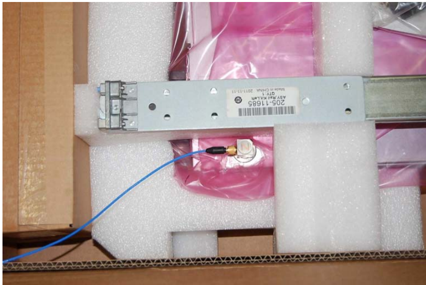
43. ábra. A gyorsulás adó elhelyezése és rögzítése a vizsgálati mintán
