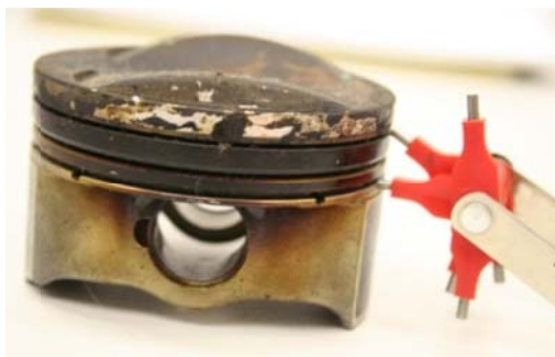
2.18 ábra: Dugattyú gyűrűhornyában az olajvisszavezető furatok ellenőrzése fuvókamérővel
