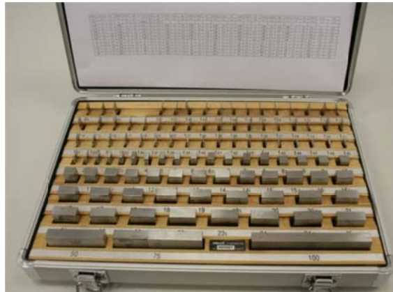
2.1 ábra: Mérőhasábkészlet, a rendszeres és véletlen hibák táblázatával
