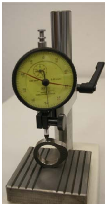
3.8 ábra: Bütyök alapkörátmérőjének mérése mérőórával
