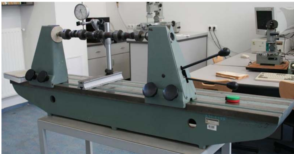
10.15 ábra: Vezérműtengely csapágyhelyének ütész mérése csúcspadban mérőórával
