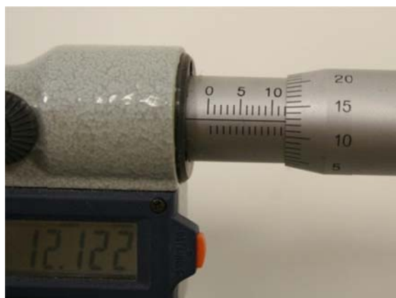
3.7 ábra: Mikrométer leolvasása
