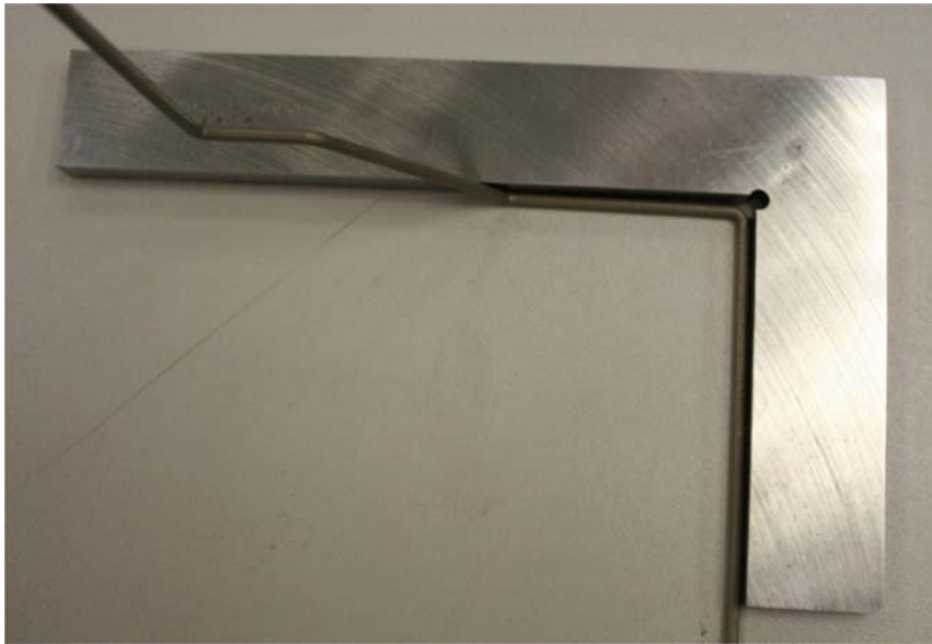
2.15 ábra: Merőlegesség ellenőrzése derékszöggel
