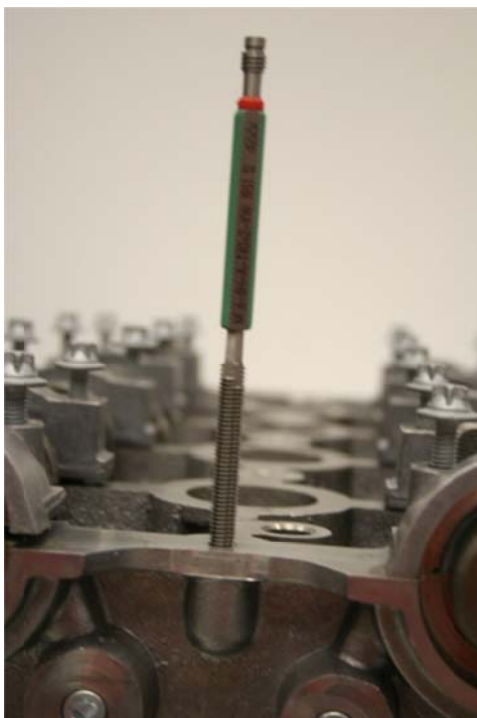
2.8 ábra: Menetes furat ellenőrzése kétoldali menetidomszerrel
