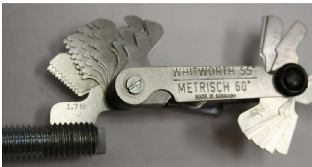
2.6 ábra: Külső menet vizsgálata menetfésűvel
