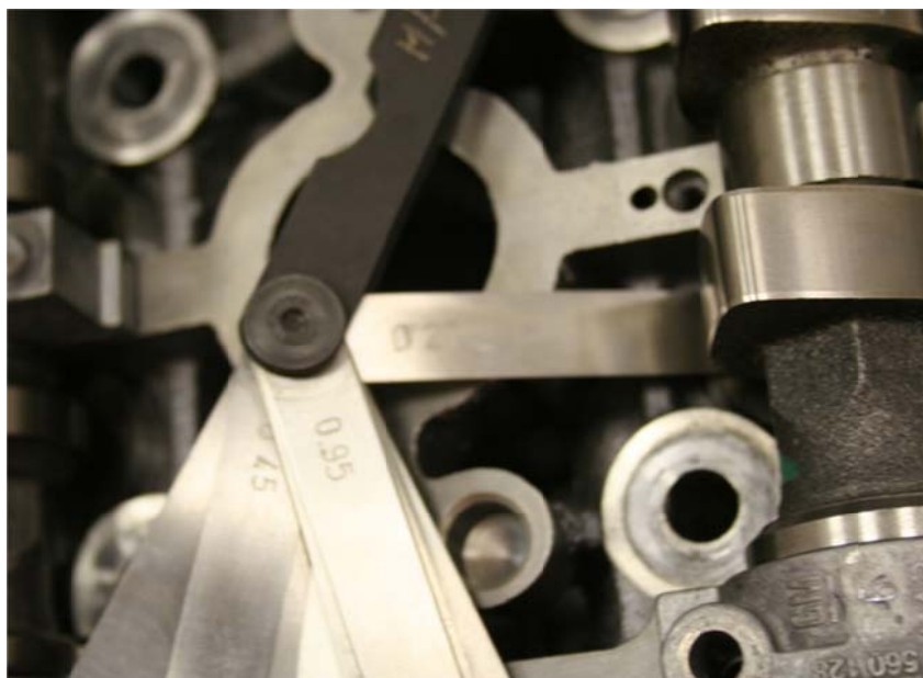
2.14 ábra: Szelephézag ellenőrzése hézagmérővel
