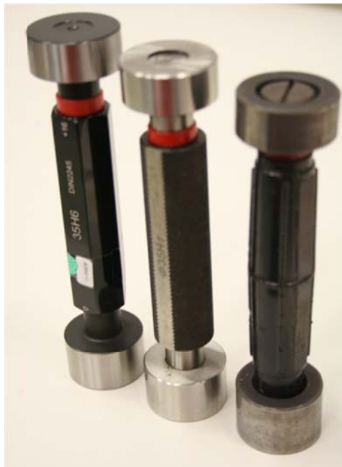
2.11 ábra: 35H6-os (bal oldali) és 35H7-es dugós idomszerek (középső és jobb oldali)
