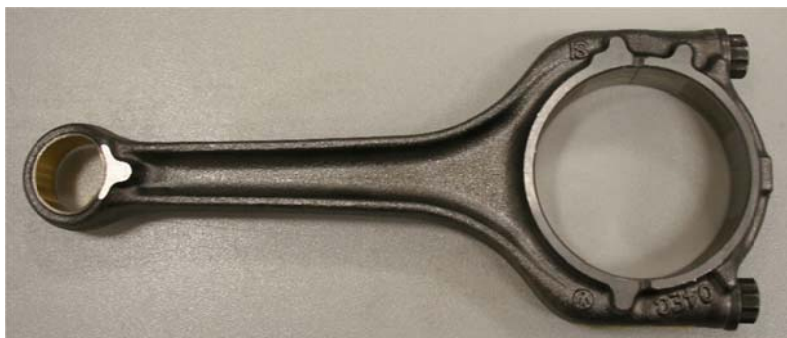
1.2 ábra: Belsőégésű motor hajtókar
