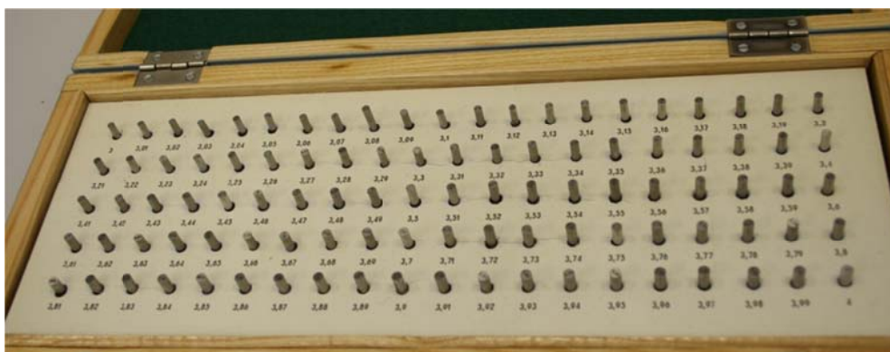
2.19 ábra: Mérőcsapkészlet, átmérők 3-4 mm között 0,01 mm-enként
