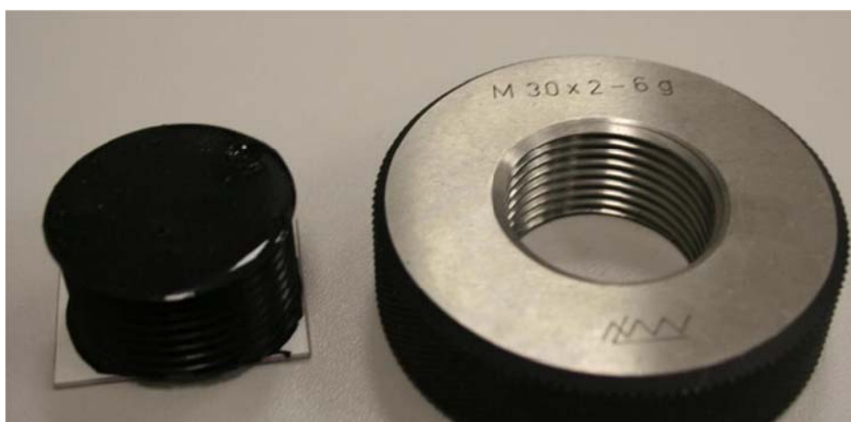
2.7 ábra: Gyűrűs menetidomszer és a menetről készített szilikolenyomat
