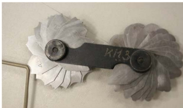
2.9 ábra: Külső lekerekítés ellenőrzése rádiusszablonnal
