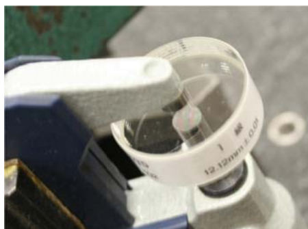
2.3 ábra: Interferenciacsíkok a mikrométer mérőfelületén
