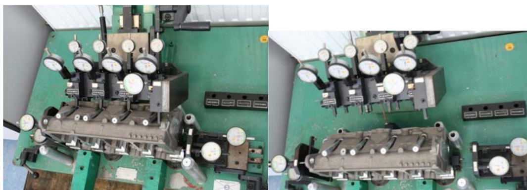
4.7 ábra: Hengerfejmérő készülék mérési és munkadarabcserelési pozícióban
