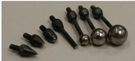
3.10 ábra: Különböző tapintók mérőórához (hegyes, sík, lekerekített, keskeny/hosszú/sík és különböző átmérőjű gömbök)
