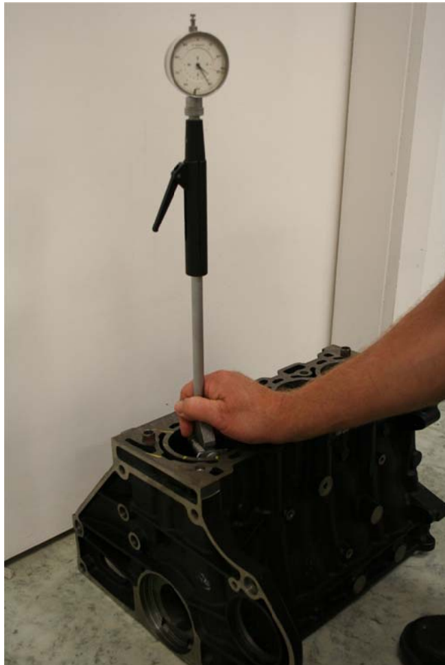
3.12 ábra: Hengerfurat mérése mérőórás furatmérővel
