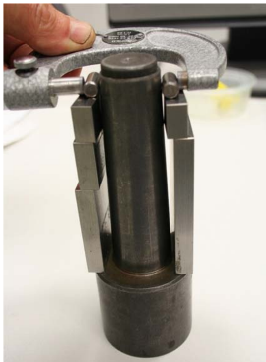
2.5 ábra: Kúp mérése csapok között mikrométerrel, a csapok helyzetét mérőhasábok biztosítják
