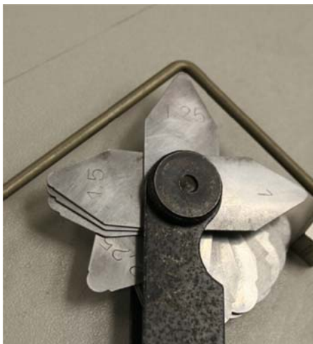
2.10 ábra: Belső ív ellenőrzése rádiusszablonnal
