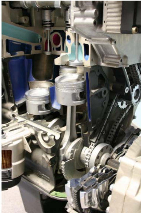
1.1 ábra: Belsőégésű motor (metszet)
