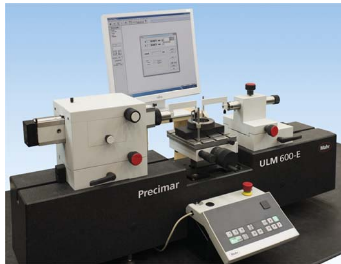
3.17 ábra: Beállítógyűrű mérése, vagy kalibrálás korszerű hosszmérőgépen (MAHR ULM600)
