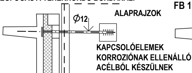
5. FÜGG. FALELEM-TETŐFÖDÉM CSATL. 31. ÁÉV. MEGFOGÁS A TEHERHORDÓ BORDÁNÁL.
