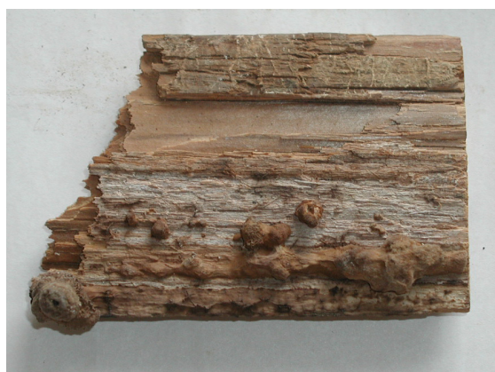
Obr. 2. Odstraňovanie prehnitých častí debnenia, drevokazná huba, 5 rokov užívania
