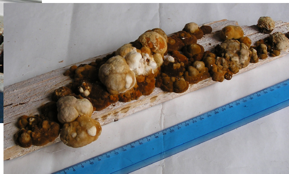
Obr. 5. Odstraňovanie prehnitých častí debnenia, drevokazná huba, 4 roky užívania
