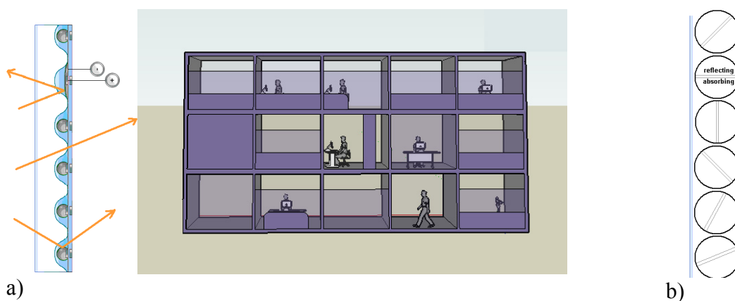
Obr. 1 Princíp funkcie povlaku z tekutej suspenzie a príklady možných zmien optických vlastností zasklení jednotlivých zón budovy (a) a systém Gyricon (b) [2]
