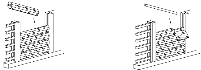
6. ábra: Pólyás építésű favázás vályogfalak
