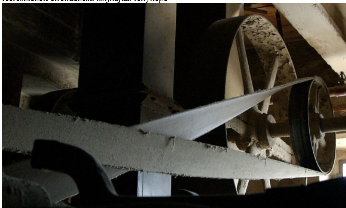
Terelőgörgős, (-tárcsás) elrendezésű szíjhajtás modellje
