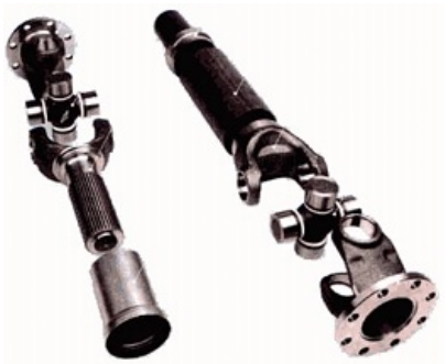
5.15. ábra. Szétszerelt kardánkapcsoló
