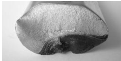
4.17. ábra. Fáradt törés
