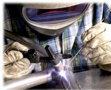
3.9. ábra. Argon védőgázás wolframelektrodás ívhegesztés AWI munkaállomása és művelete
