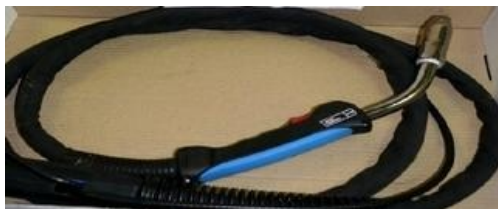
3.8. ábra. Hegesztőpisztoly készlet lánghegesztéshez, CO 2 védőgázás hegesztőpisztoly
