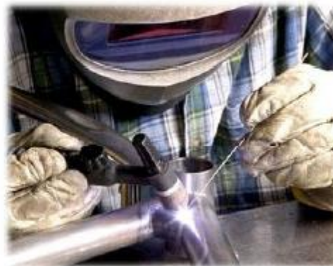
Argon védőgázas wolframelektrodás ívhegesztés AWI munkaállomása és művelete
