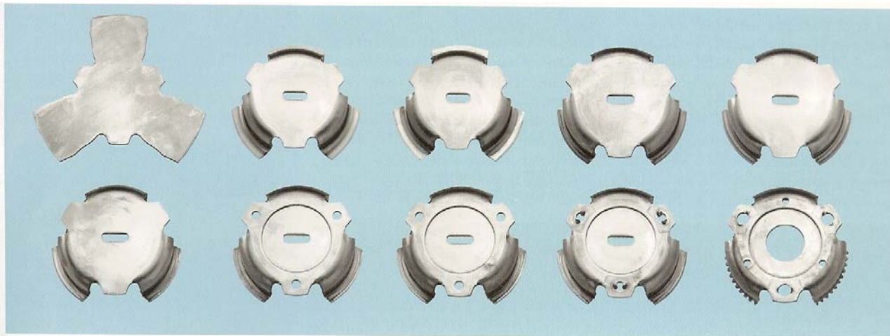
Fertigung in 9 Umformstufen mit vorgeschaltetem Zick-Zack-Platinenschnitt
