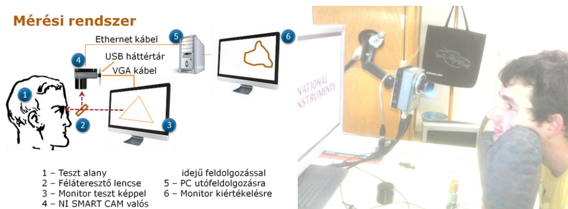
3. ábra. A 2014-es NI pályázaton nyertes valós idejű szemmozgáskövető rendszer
