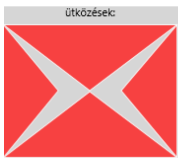
8. ábra. Az egyes falakra ható „nyomás”, ütközés szám ábrázolása. (A két oldalsó falra kisebb ütközésszám volt megfigyelhető, mint az aljára, tetejére.)
