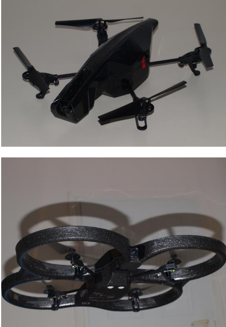
1. ábra. Az AR.Drone 2.0 kültéri és beltéri testtel felszerelve
