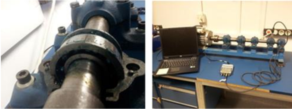
4. ábra. A csapágyvizsgáló tesztpad
