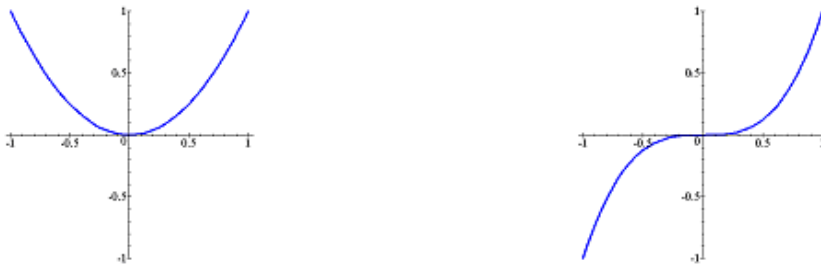
14. ábra. Az x \mapsto x^2 és az x \mapsto x^3 függvény grafikonja
