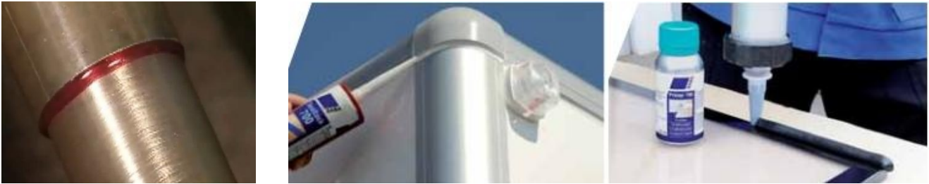
3.21. ábra. Csövek, ragasztás a gyakorlatban
