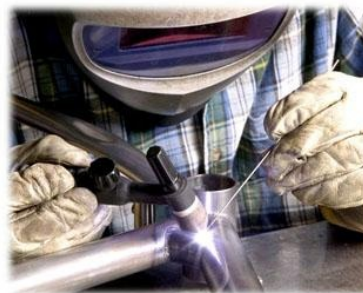
3.9. ábra. Argon védőgázos wolframelektrodás ívhegesztés AWI munkáállomása és művelete
