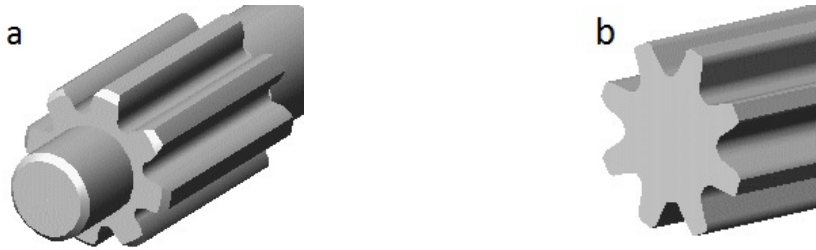
Abbildung 2.47: a) Keilwelle mit evolventenförmigen Flanken, b) Mitnehmer mit Keilzahnprofil
