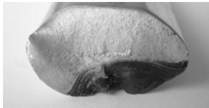
Abbildung 1.1: Ermüdungsbruch einer Pleuelstange
