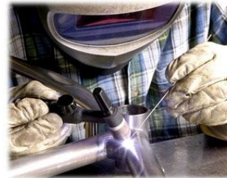
Abbildung 3.9: Wolfram-Inertgasschweißen mit Argon Schutzgas - Arbeitsstation und Durchführung des WIG-Schweißverfahrens. Website verfügbar.
