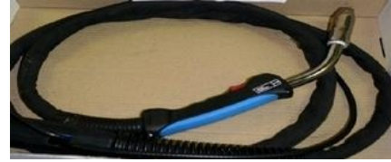
Abbildung 3.8: Schweißbrenner-Set zum Gasschweißen, CO 2 -Schutzgas-Schweißbrenner
