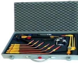
Abbildung 3.8: Schweißbrenner-Set zum Gasschweißen, CO 2 -Schutzgas-Schweißbrenner
