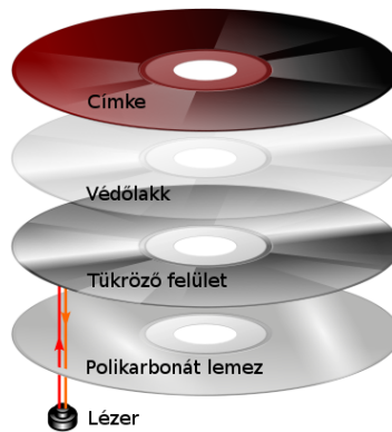
7.7. ábra. Az optikai lemez rétegei, felépítése
