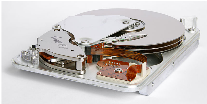
7.5. ábra. A merevlemez-meghajtó szétszedett állapotban, három merevlemezzel
