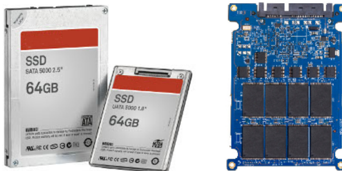
7.6. ábra. A SATA buszra csatlakoztatható SSD meghajtók és belső felépítésük
