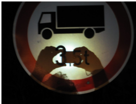
8.15. ábra. Kresztábla fényvisszaverő rétegének hatása
