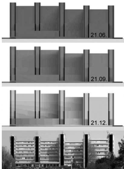
9. ábra: Modellezett fények és árnyékok a déli homlokzaton az év három különböző napján, és az energiagyűjtésre legkedvezőbb felületek egy fotomontázsán jelölve
