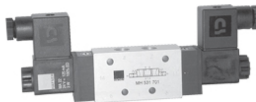
Elektromos vezérlésű, elővezérelt 5/3-as szelep, stabil középállással, középállásban zárt kivitelben Pl.: MH 531 701
