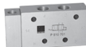
Pneumatikus vezérlésű, 5/2-es, monostabil, rugó-visszatérítéses szelep Pl.: P 511 701
