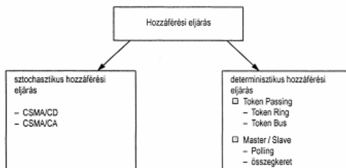
5.6. ábra. A buszhozzáférési eljárások csoportosítása
