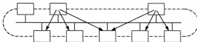
5.8. ábra. Token Bus buszhozzáférési mód
