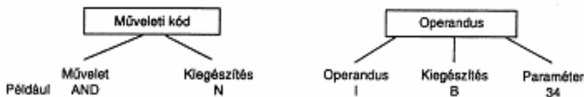
4.2. ábra. Az utasításlistás programnyelv egy utasításának felépítése
