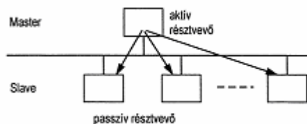
5.9. ábra. Master/Slave hozzáférési mód
