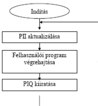
4.18. ábra. A ciklikus programvégrehajtás folyamata
