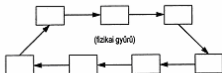
5.7. ábra. Token Ring buszhozzáférési mód
