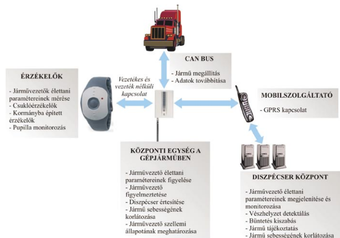
1. ábra: járművezetők élettani paramétereit elképzelt monitorozó rendszer lehetséges informatikai felépítése
