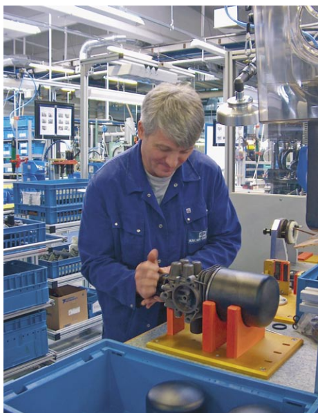
A Knorr-Bremse Fékrendszerek Kft. gyárában készül a ZB44. Monoblokk levegő-előkészítő egység integrált olajleválasztóval (APU – Air Processing Units)
