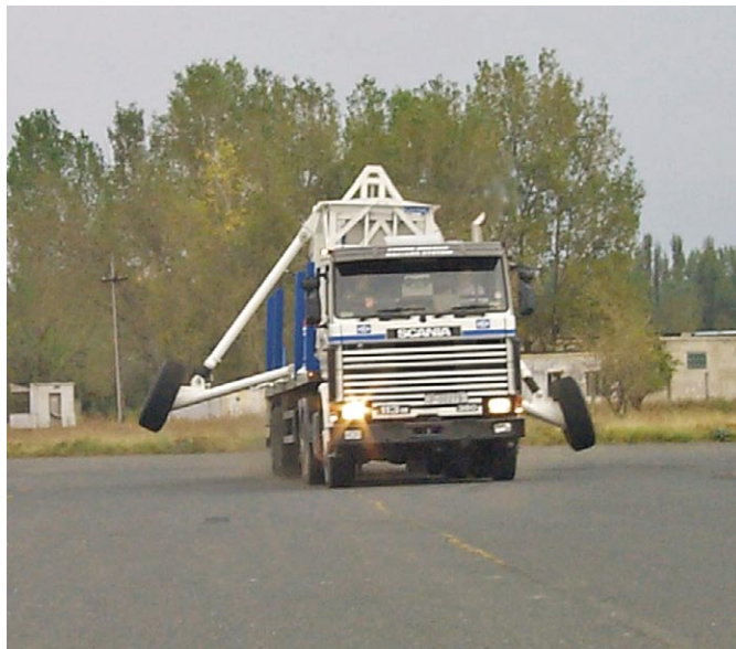
A pótkocsi EBS az RSP- (Roll Stability Program) programmal javítja a pótkocsik stabilitását, a felborulást okozó menetállapot felismerésével, és az ezt követő beavatkozással. A rendszer fejlesztése a járművek széles körén végzett próbapályás vizsgálatok eredményének kiértékelése alapján történik. Az ábrán egy járműszerelvény látható vizsgálat közben
