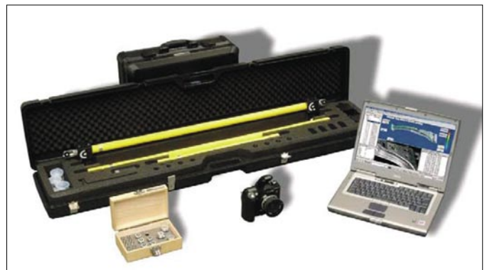
2. ábra: TRITOP mérőrendszer
