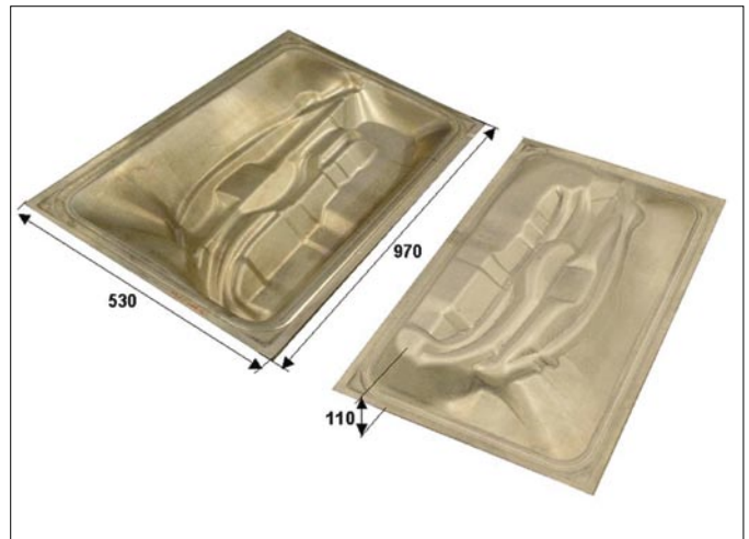
Bild 6 - Türinnenverstärkung aus Magnesium AZ31 hergestellt durch pneumatisches Tiefen bei 400°C
