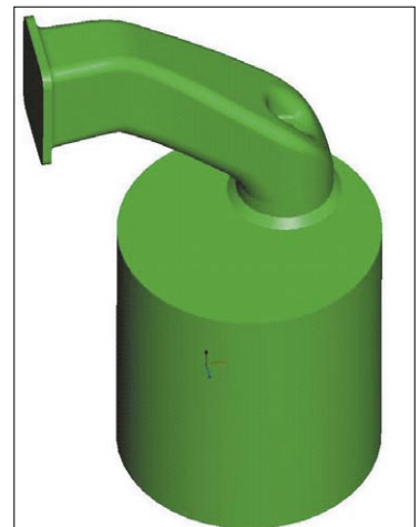
1. ábra: dízelmotor hengerének és szívócsatornájának Pro/E modellje
