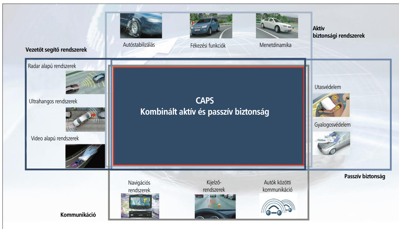
6. ábra: Bosch CAPS-rendszer – a meglévő aktív és passzív biztonsági rendszerek kombinációja
