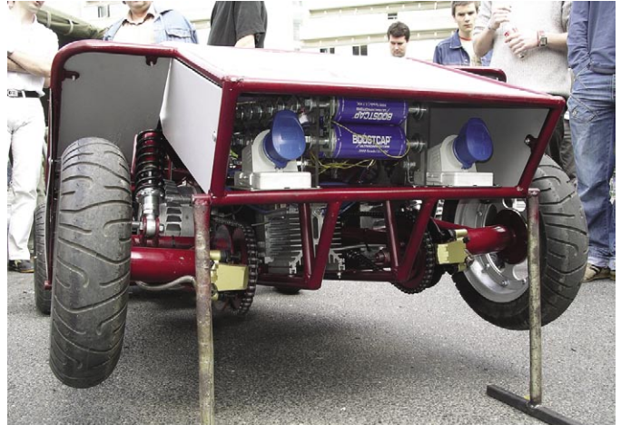
Szuperkapacitás, akkumulátor, tárcsafék, verseny futómű – BME, Elektronikus Jármű- és Járműirányítási Tudásközpont – 2. helyezett
