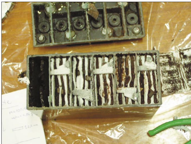
3. ábra: a cella geometriai méreteinek meghatározása az akkumulátor szétszerelésével
