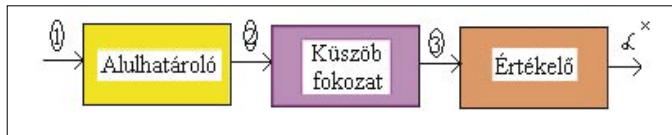
24. ábra: rögzített mérő egyszerűsített változata
