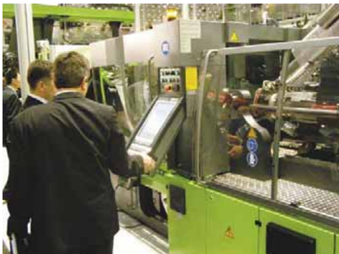
9. ábra: az Engel víz ellennyomásos fröccsöntőgépe
