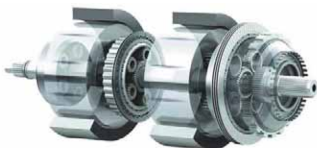
A kettős üzemű hibrid hajtórendszer mechanikus szerkezeti elemei
