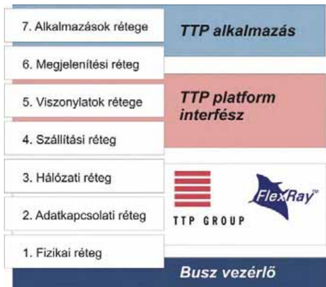
4. ábra: TTP/C-FlexRay technológia konverzió a protokoll adaptációs réteg közbeiktatásával
