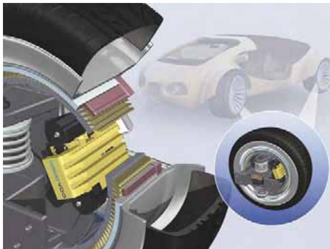
A Siemens VDO kerékagy motorjának felépítése
