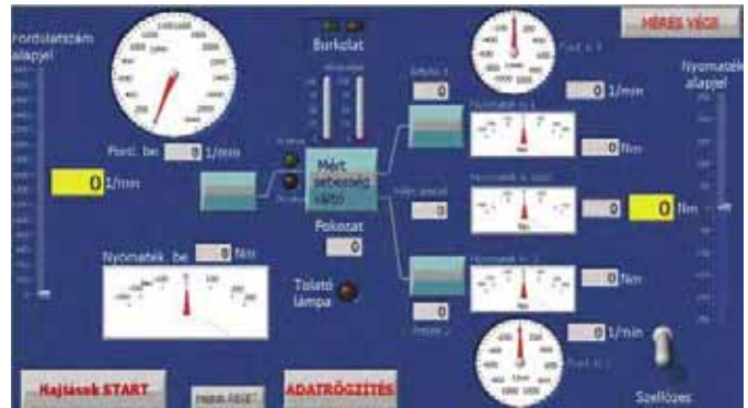
8. ábra: a kézi üzemmód vezérlő képernyője
