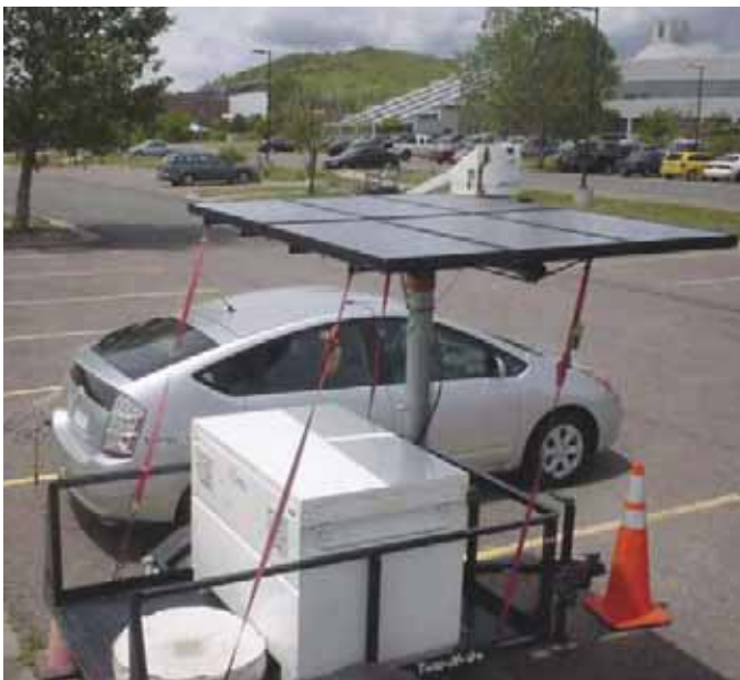
A plug-in hibrid Toyota Prius akkumulátora napenergiával is tölthető
