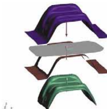
2. ábra: szerszámfelületek, alakítatlan terítéssel
