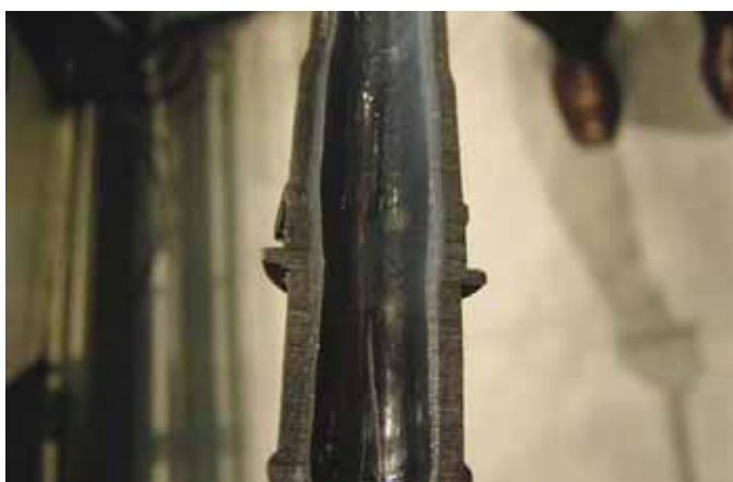
10. ábra: a WIT-eljárással gyártott termék keresztmetszete (kívül PBT, belül PP)
