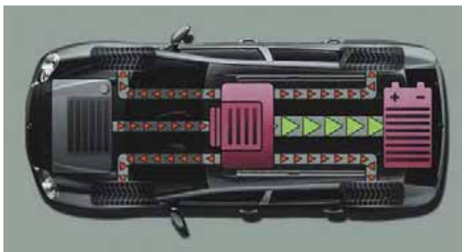
A Porsche Cayenne Hybrid erőátvitelének egyidejű mechanikus és villamos hajtás üzemmódjában
