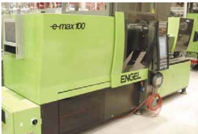
11. ábra: az Engel teljesen elektromos fröccsöntőgépe
