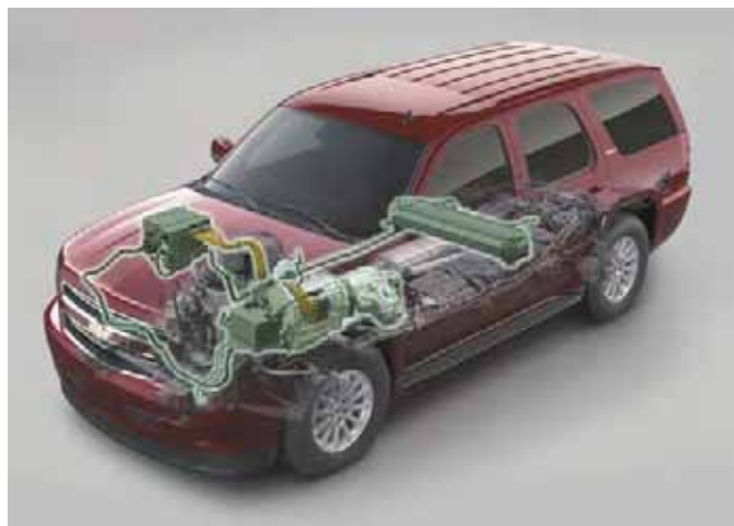
A kettős üzemű hibrid hajtórendszer, az év zöldautójának (2008 Green Car of the Year®) választott Chevrolet Tahoe Hybrid SUV-ben
