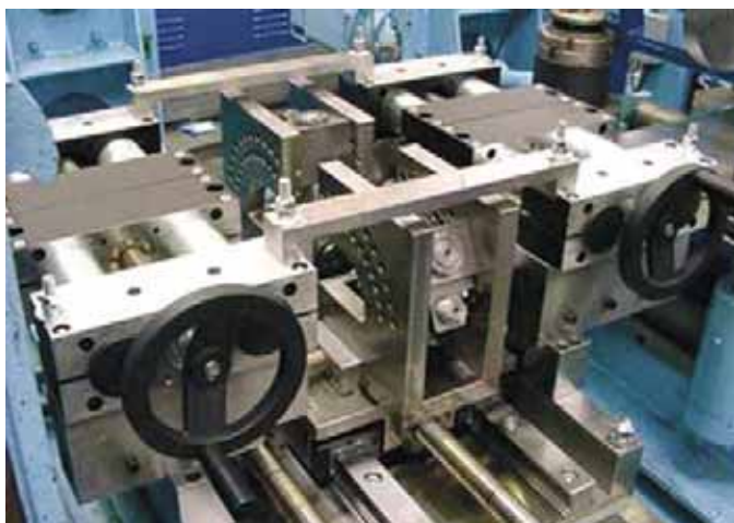
2. ábra: szerszámrendszer a változó keresztmetszetű szelvények hengerléséhez
