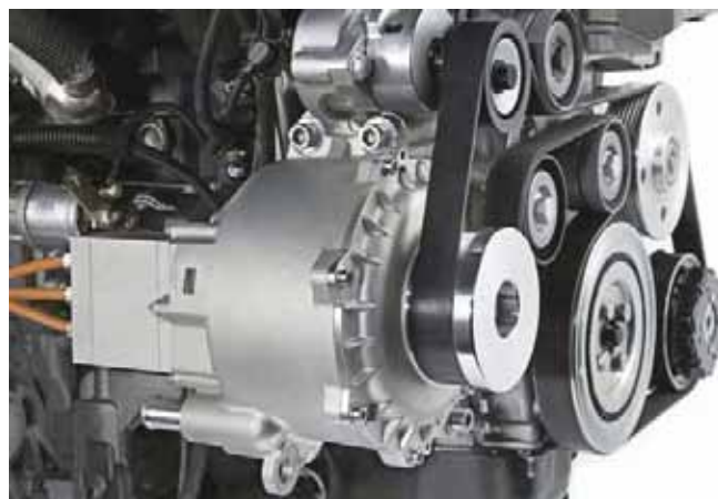
A legegyszerűbb hibrid hajtás egyetlen indítógenerátorból áll (Opel Corsa)
