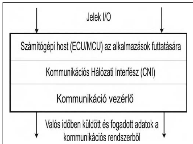
3. ábra: egy kommunikációs csomópont (Node) tipikus struktúrája
