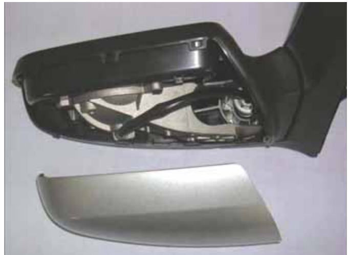
1. ábra: az Opel Zafira külső visszapillantó tükrének belseje, a beépített tükörtartóval
