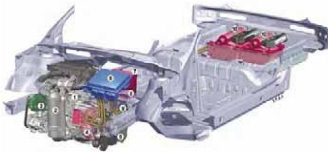
A Peugeot 307-es és a Citroën C4 Hybride HDi dízelhibrid hajtórendszerének felépítése. 1. Soros, 4 hengeres dízelmotor. 2. Dízel részecszeszűrő. 3. Start-stop rendszer. 4. Állandó mágnesgerjesztésű szinkrongép. 5. Automatikus kapcsolású, 6 fokozatú sebességváltó. 6. Inverter, villamos teljesítményfokozat. 7. 12 V-os akkumulátor. 8. A hibrid hajtás vezérlőegysége. 9. Tápkábelek. 10. Nikkel-metálhidrid akkumulátor
