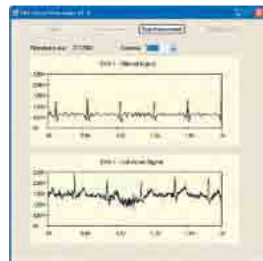
15. ábra: EKG-mérés erős mozgások mellett
