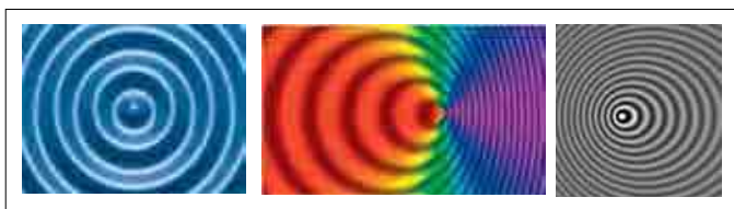
1. ábra: álló és mozgó forrás hullámképei
