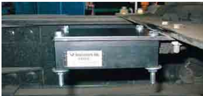
14. ábra: VDSU felfogatása tartólemezzel
