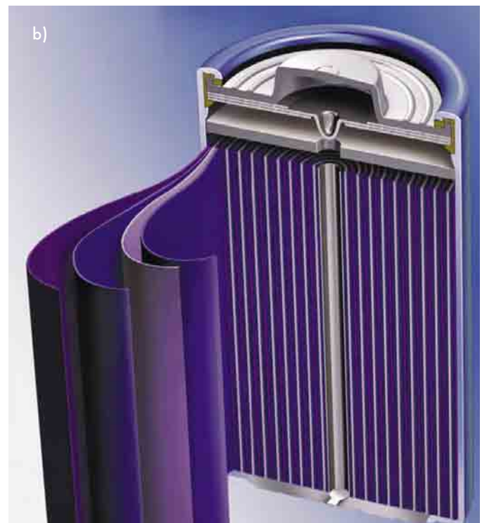
A lítium-ion akkumulátorcellák elektródjait elektrolitbevonatú szeparátorszalag választja el egymástól (a). A Li-ion telepek hármasszalagtekercsből állnak (b)
