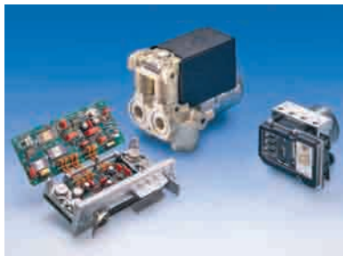
Az ABS egykor és ma: bal oldalon egy ABS hidraulika és vezérlőegység 1978-ból, jobbra a lényegesen kompaktabb kialakítású újgenerációs ABS
