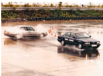
Nedves útfelületen való fékezéskor az ABS nélküli gépkocsi könnyen irányíthatatlanná válik
