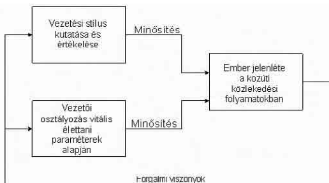
1. ábra: a kialakított visszacsatolt forgalomszimulációs modellstruktúra
