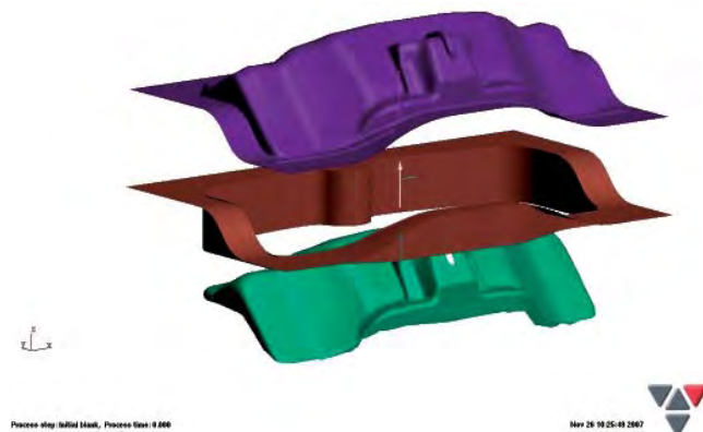
3. ábra: valós, szkennelt szerszámfelek
