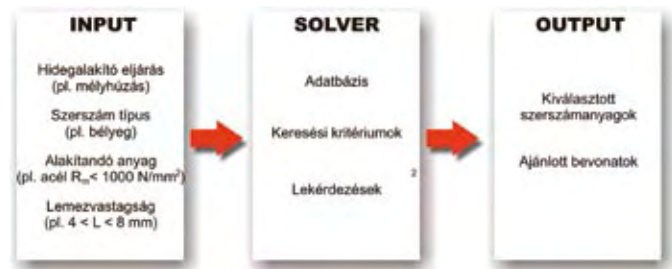
2. ábra: a szerszámanyag és felületkezelési eljárás kiválasztási stratégiájának szemléltetése
