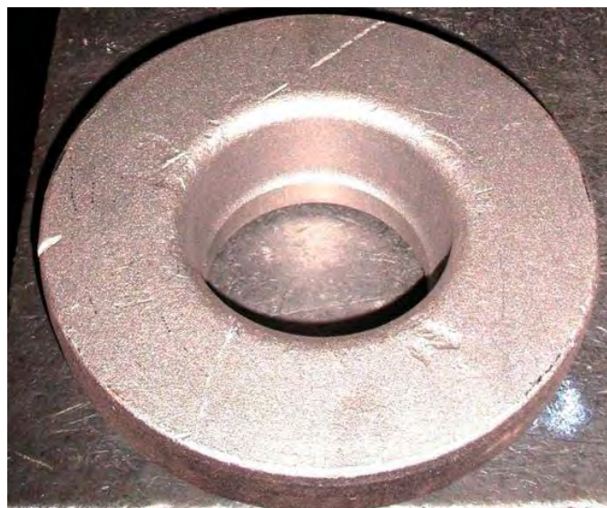
16. ábra: a peremes csomk próbagyártási darabja
