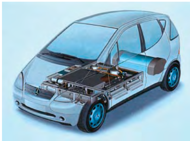
17. ábra: a Mercedes-Benz tüzelőanyag-cellás járművének hajtóelemei padló alatti elrendezésűek
