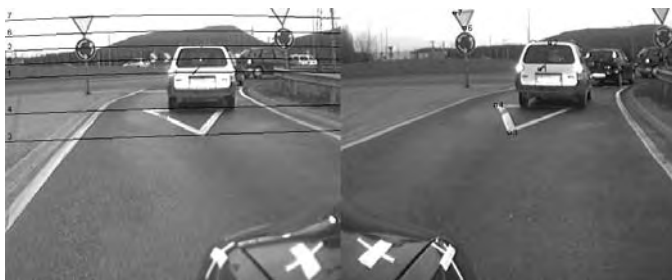
5. ábra: néhány kijelölt pont a jobb oldali képen, és a nekik megfelelő, radiálisan torzított epipoláris egyenesek a bal oldali képen a lencsetorzítások és a fundamentális mátrix ismeretében, valós közötti felvételen. Az epipoláris kényszer minden pontra teljesül
