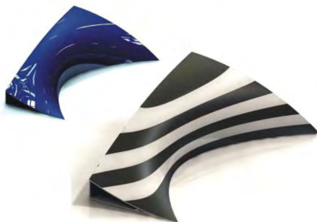
5. ábra: a valós és a moiré-csíkokkal borított karosszériaelem modellje
