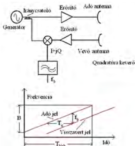
8. ábra: frekvenciamodulált, állandó üzemő radar külön adó- és vevőantennával
