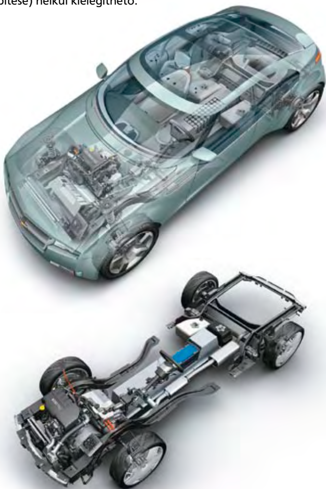
16. ábra: a GM Chevrolet Volt HEV padló alatti gerincalagútjába épített hajtóelem-elrendezését (a) Európában az Opel Flextreme viszi tovább (b)
