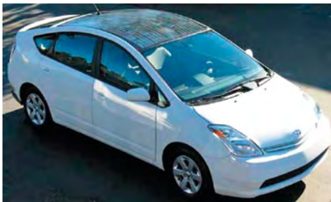
8. ábra: a Prius II tetőfelületére telepített napelemek néhány 100 wattos energiatermelése is segíti a jármű áramellátását
