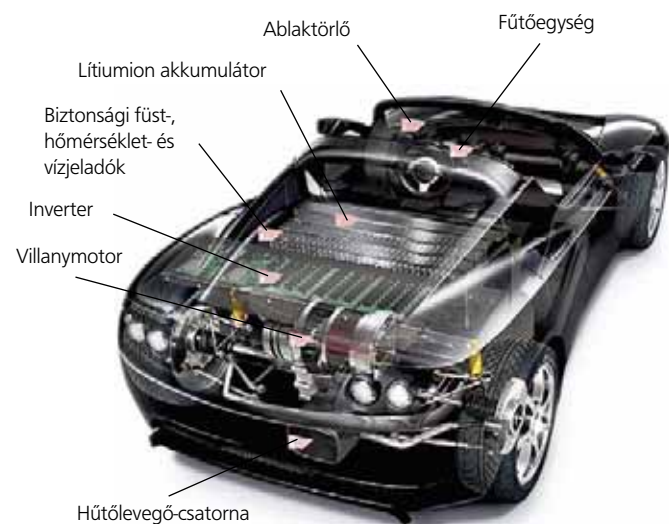
27. ábra: a Tesla Roadster erőátvitelének főegységei
