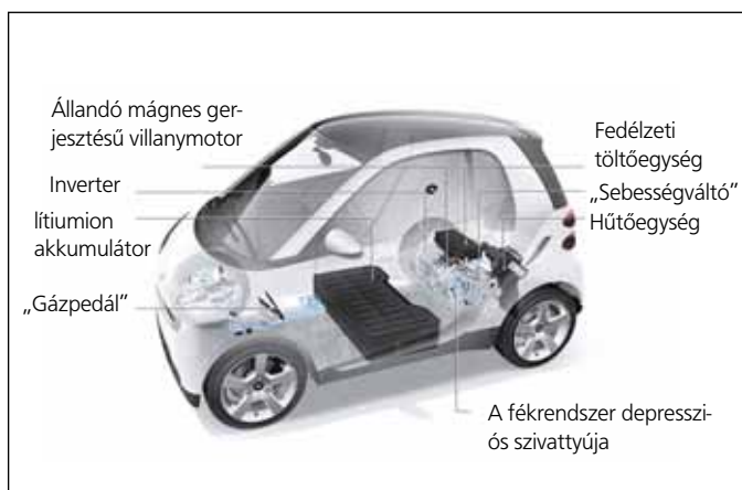
28. ábra: a villamos hajtású Smart szerkezeti főegységei
