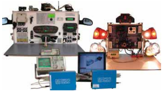
5. ábra: PSA és VW CAN-VAN-LIN kommunikációs próbapad, valamint DecomSYS kommunikációs platform
