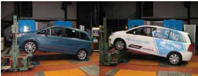
7. ábra: az Opel Zafira 1,6 és az Opel Zafira 1,6 CNG kerékkerheléseinek mérése
