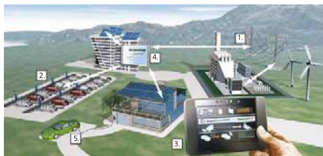
1. Vezetékhálózat, 2. Gyorstöltős parkoló, 3. Műszerfali egysége, 4. Áramellátó központ, 5. Házi töltőegység
