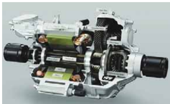
20. ábra: a Honda FCX Clarity hajtóelemeinek elrendezése (a és b), kerékagymotorja (c) és villamos hajtóegysége (d)
