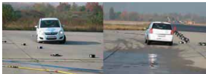
10. ábra: Opel Zafira 1,6 CNG keresztirányú dinamikai mérés közben
