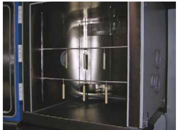
10. ábra: hőkamrában elhelyezett alkatrész
