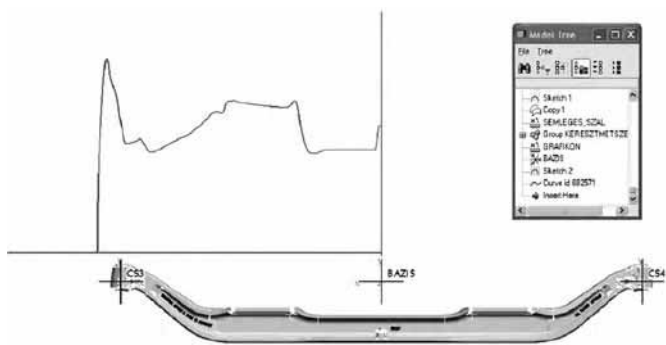
2. ábra: a kovácsdarab sorja nélküli vetületterület-diagramja
