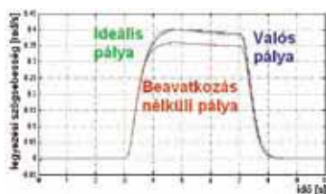
8. ábra: kormányzóg-egységugrás teszt kapott legyezési szögsebesség alakulása aktív első kerékkormányzás esetén
