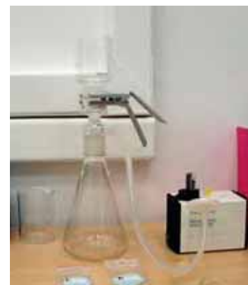
2. ábra: vákuumos szűrőberendezés
