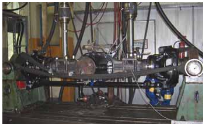
4. ábra: MAXS hajtott mellső futómű függőleges fárasztási vizsgálata
