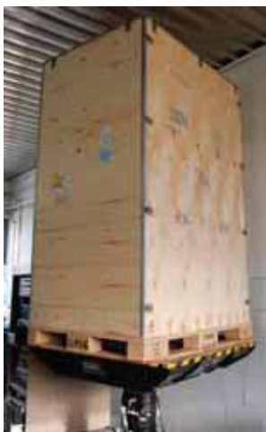
6. ábra: rázási igénybevétel szimulálása
