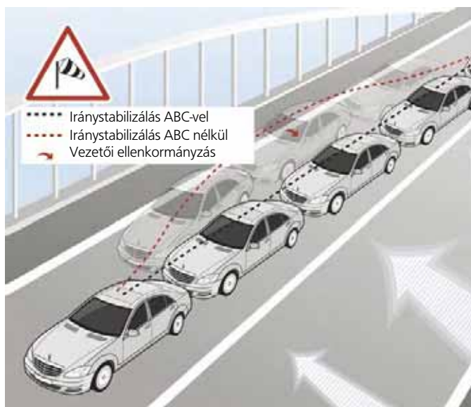
7. ábra: az Active Body Control használata oldalszél esetén, minimálisra csökkenti a vezető ellenkormányzó beavatkozásának igényét
