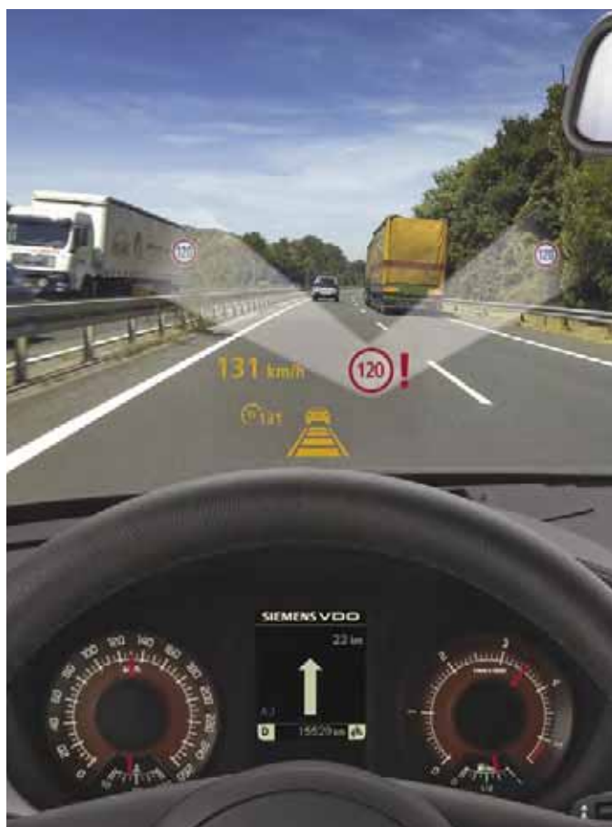
6. ábra: a DISTRONIC Plus sebességhatároló asszisztense folyamatosan figyeli a közúti jelzőtáblákat és sebességtűllépés esetén figyelmezteti a vezetőt
