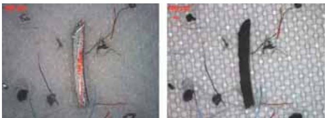
7. ábra: fémrészecske, világos látómező és polarizált fény megvilágításban
