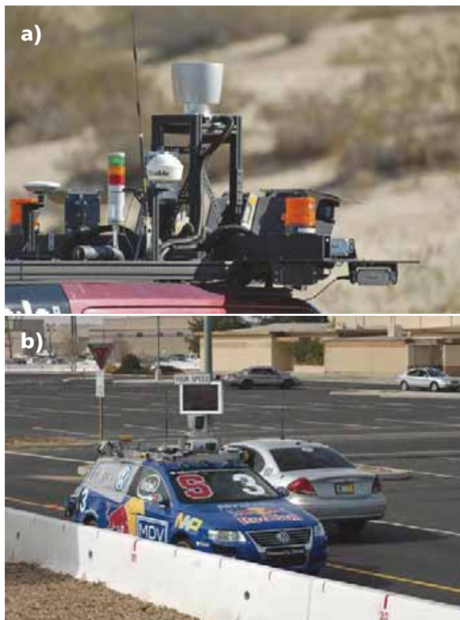
19. ábra: a DARPA Challenge verseny, sofőr nélküli járművein antenna erdő (a) érzékeli a városi forgalmat (b)
