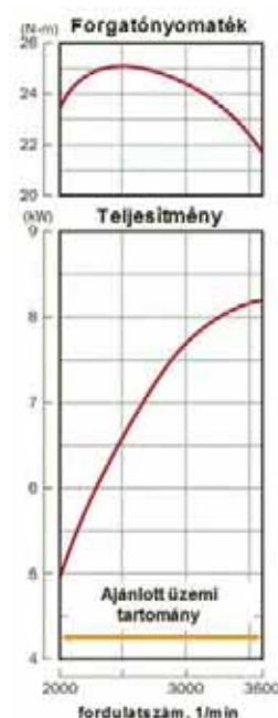
4. ábra: a motor jelleggörbéi
