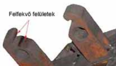
2. ábra: a robotkar szorítófelülete
