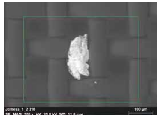
13. ábra: részecske elektronmikroszkópos képe a szűrőn
