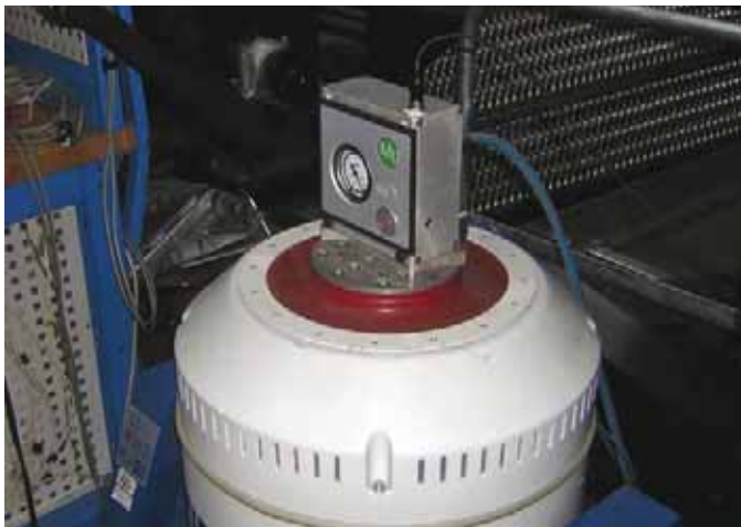
6. ábra: rázóhengerre szerelt pneumatikus alkatrész
