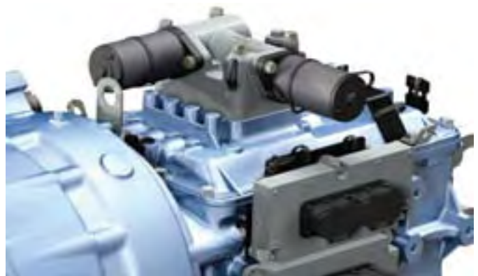
4. ábra: az EATON UltraShift és AutoShift főváltójának elektromechanikus működtetője (forrás: www.eaton.com)
