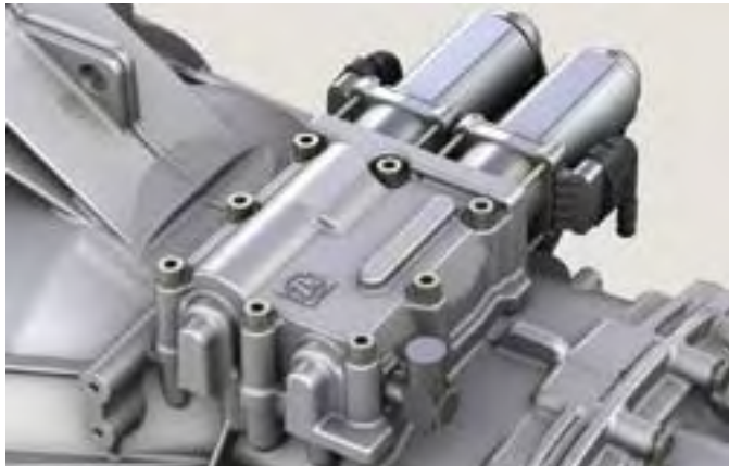
6. ábra: a ZF eTronic sebességváltó elektromechanikus működtetője (forrás: www.zf.com)
