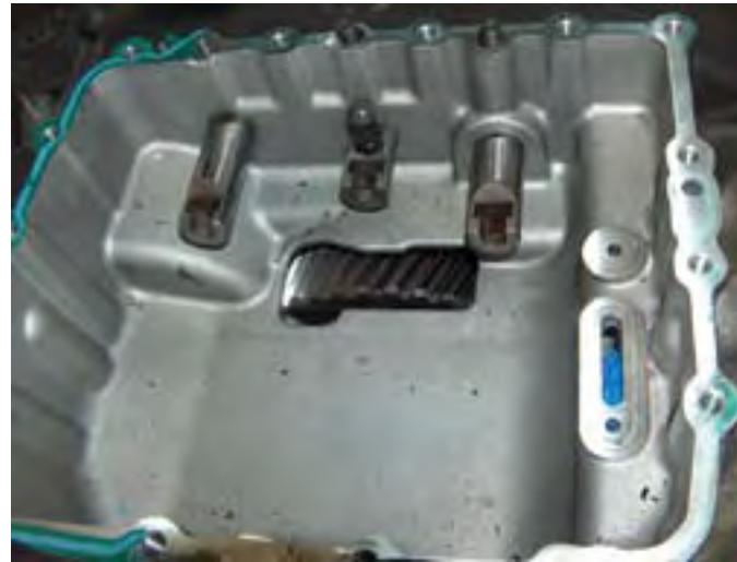
7. ábra: váltóműködtető kapcsolórúdak a működtetőegység teknőjében (a kép felső részén a reteszek nyomórugói láthatók még az eltávolítás előtt)
