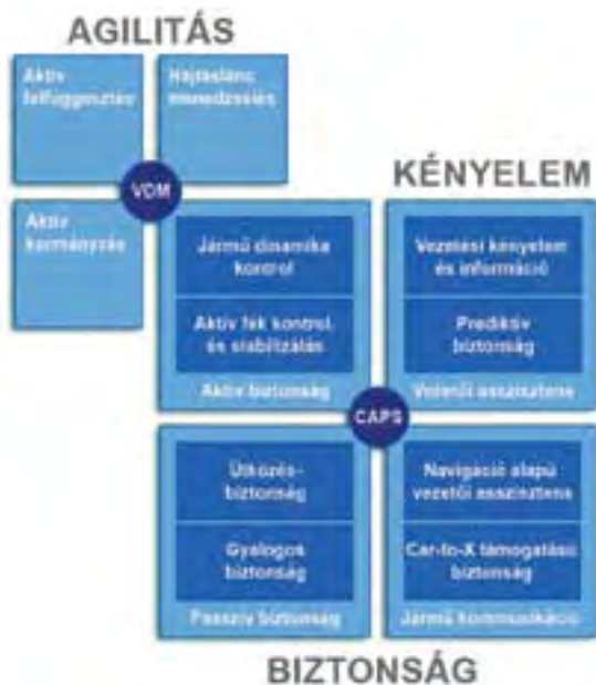
2. ábra: az utazás biztonságát, kényelmét és a jármű agilitását felügyelő szolgáltatások belső kapcsolatai. Ezen belül, a VDM járműdinamikai menedzsment (Vehicle Dynamics Management = VDM) a jármű kormányzásával, erőátvitelével és felfüggesztésével kapcsolatot tartó szoftvert és elektronikus hálózatot, a CAPS az aktív és a passzív biztonsági rendszerek kombinációját [Combined Active and Passive Safety Systems (CAPS)] adó szoftvert és elektronikus hálózatot jelent
