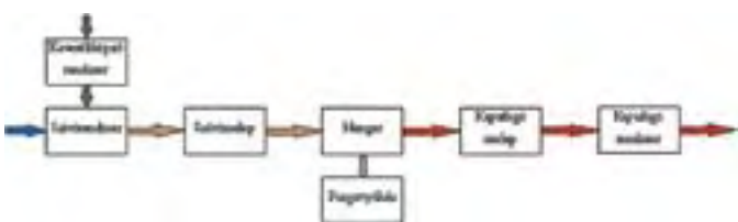
1. ábra: külső keverékképzésű motormodell blokkdiagramja
