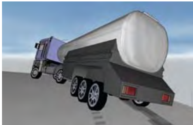
1. ábra: jármű borulékonyosságának vizsgálata járműdinamikai szimulációs programmal
