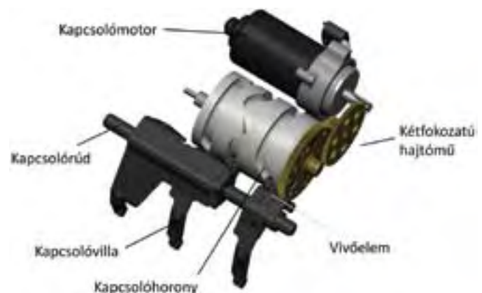
1. ábra: kapcsolódobok elektromotoros működtetéssel [2]
