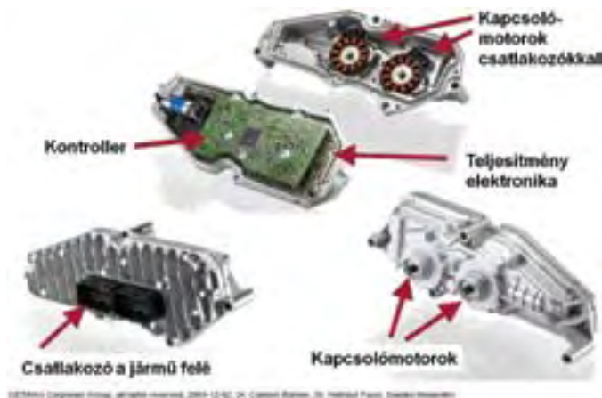
2. ábra: mechatronikus működtetőegység (MAM)[1]
