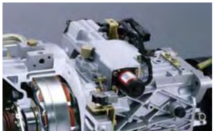
5. ábra: a Mitsubishi Fuso INOMAT II sebességváltó elektromechanikus működtetője (www.mitsubishi-fuso.com)
