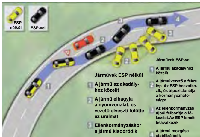
8. ábra: az ESP jellegzetes beavatkozásai
