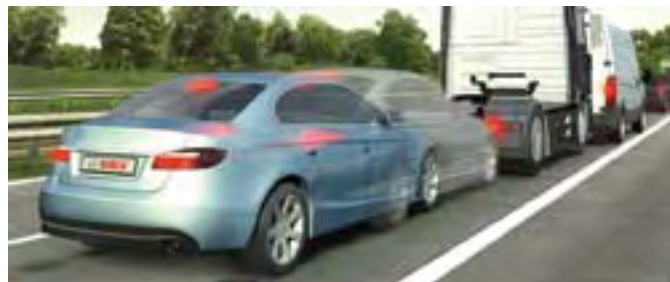
15. ábra: a készenléti vészfékező asszisztens méterekkel rövidíti meg a fékutat
