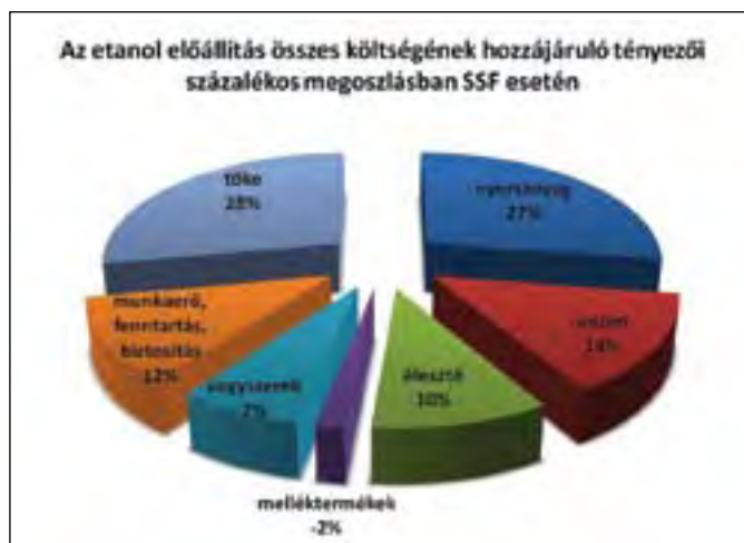
6. ábra: az etanol-előállítás összes költségének hozzájáruló tényezői százalékos megoszlásban szimultán szaccharifikáció és fermentáció (SSF) esetén. Forrás: saját ábra [6] adatainak felhasználásával
