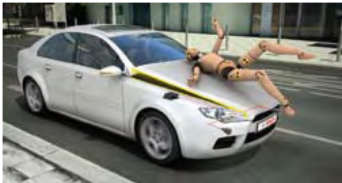
25. ábra: a gyalogosvédelem, érzékelők jeleire megemelkedő motortetővel való „lágy” ütközést jelent
