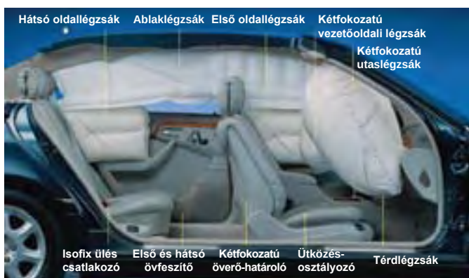
9. ábra: korszerű gépkocsi, érzékelő-vezérelt passzív visszatartó rendszere
