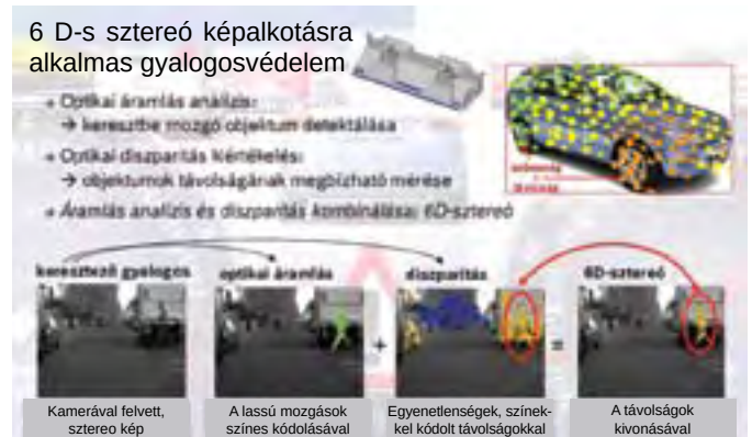
23. ábra: a sztereokamera hatdimenziós képeinek kiértékelése
