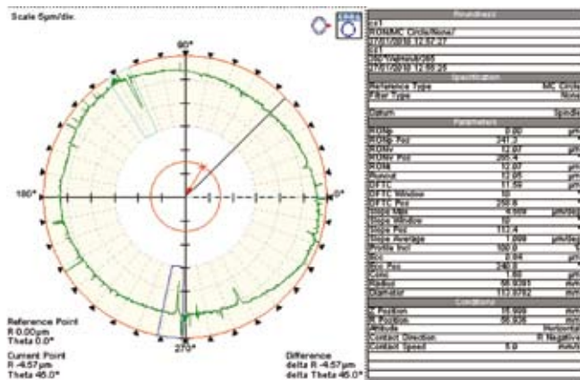
3. ábra: az első csapágyhely mérőlapja a köralak és az egytengelyűségi hibákkal
