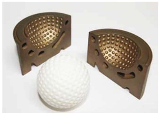
8. ábra: formakövető hűtőrendszer fröccsöntőszerszám formaadó részeiben [2]
