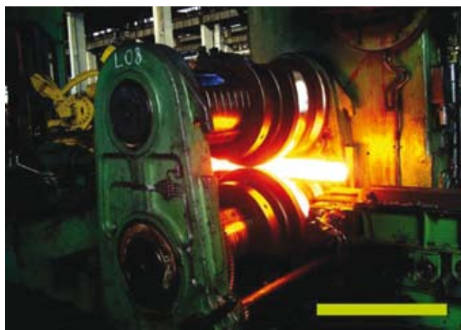
1. ábra: RW3 típusú kovácshenger munka közben
