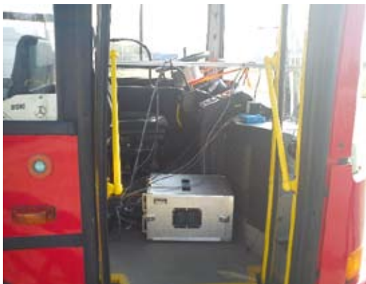
6. ábra: a beépített kormányrobot és fékvezérlő kommunikációs vonal
