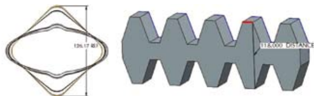
10. ábra: a fogaslécyszerű tesztmodell geometriája
