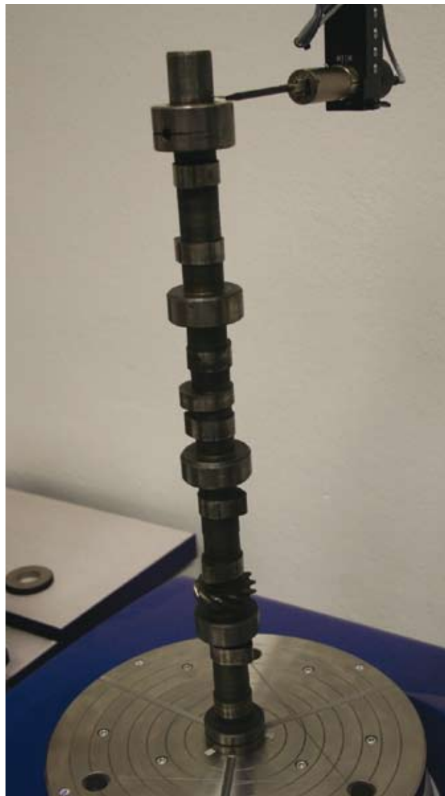
1. ábra: vezérműtengely behajtófelületének köralakmérése
