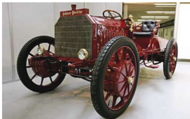
3. ábra: a Lohner-Porsche féle kerékagymotoros autó 1900-ból (Forrás: [3])
