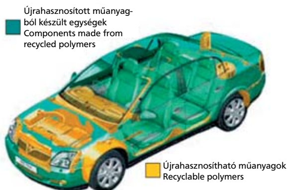
1. ábra: Opel Vectra típusú személygépjárműben felhasznált műanyagok elhelyezkedése [8] Figure 1: recycled parts in Opel Vectra [8]
