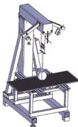
3. ábra: a tervezett és a legyártott ingás ütőmű Figure 3: the planned and produced impact testing machine
