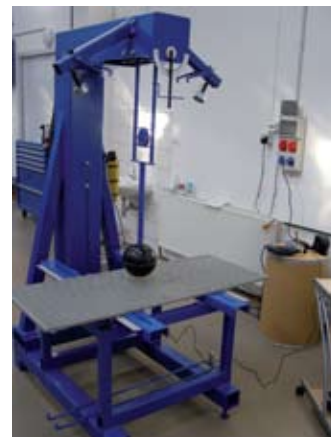
3. ábra: a tervezett és a legyártott ingás ütőmű Figure 3: the planned and produced impact testing machine
