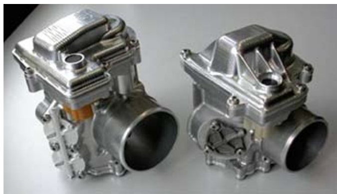
3. ábra: PBS feltöltőmodulok, balról a nehéz kategóriák számára, jobbról a könnyebb járműkategóriák részére Figure 3: PBS charging modules for heavy categories on the left and lighter vehicles on the right side
