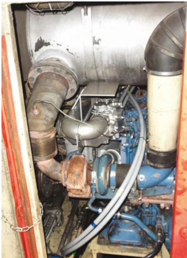
10. ábra: a módosított levegővezetés PBS-modullal
