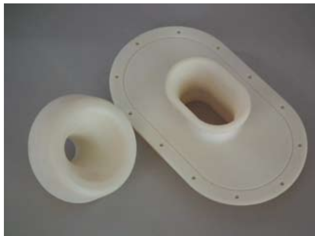
9. ábra: a levegőellátó rendszer RP-technológiával gyártott elemei
