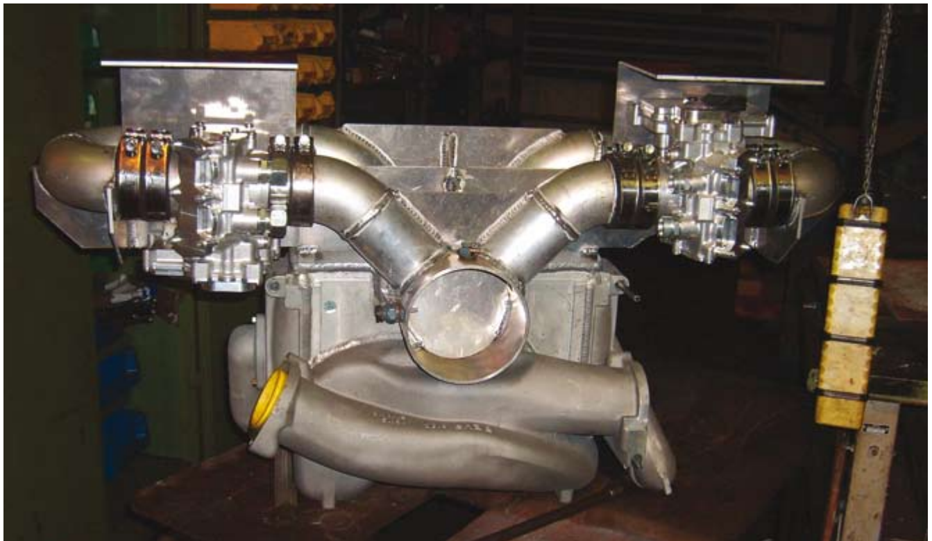
9. ábra: módosított töltőlevegő-hűtő felszerelt PBS-modulokkal
