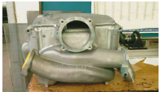
8. ábra: eredeti töltőlevegő-hűtő
