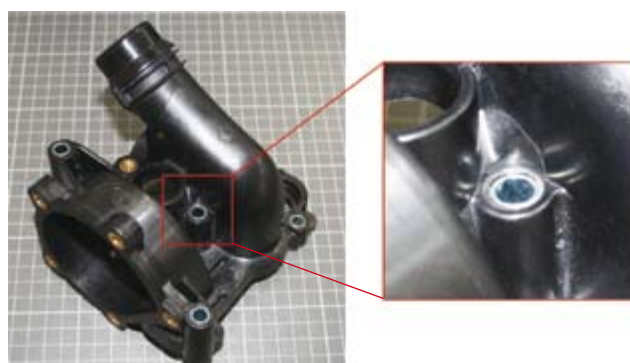
Vízpumpa fényképe és a repedés
