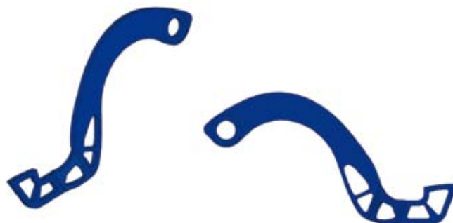
17. ábra: a pedálpár topológiai optimalizálásának eredménye
