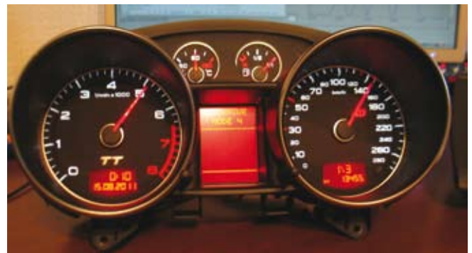
5. ábra: a műszerfal laboratóriumi RBS tesztje
