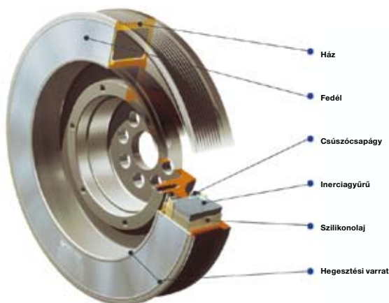
1. ábra: a viszkózus lengéscsillapító felépítése
