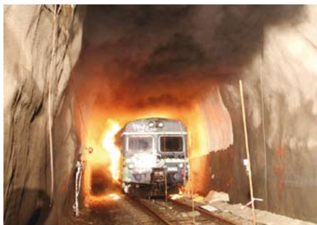
1. ábra: alagútban keletkező tűz és füst terjedése [1]
