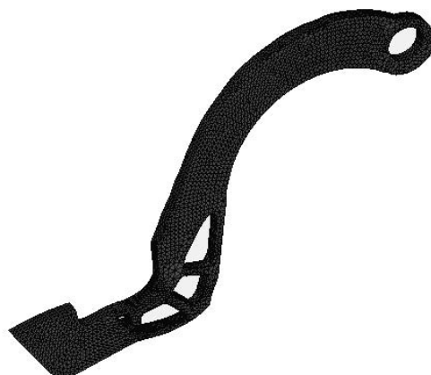
16. ábra: a pedálpár topológiai optimalizálásának eredménye a végelelemes hálózattal
