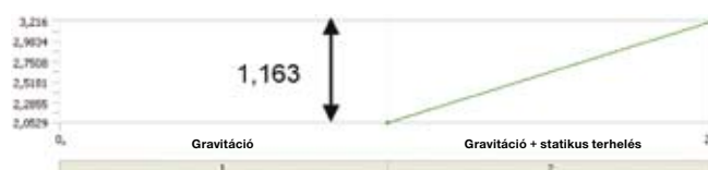
10. ábra: váz lehajlása átmetszett modell esetén
