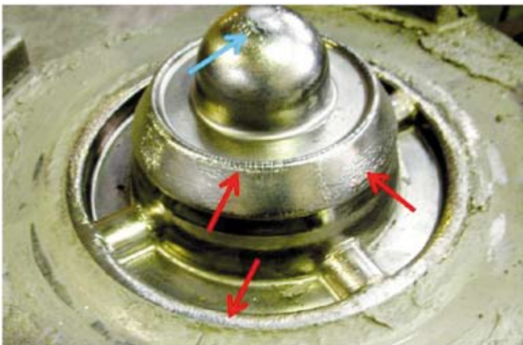
1. ábra: az ábrán egy készre sajtoló szerszámgarbitúra felső és alsó szerszáma látható. A piros nyilak a kopással, a kék nyilak az egyéb módon tönkrement felületelemeket mutatják
