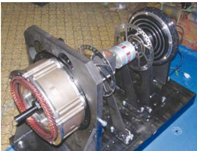
Kismotor próbapadterhelő egység: fékező, hajtó villamos gép, mechanikus fékek, nyomatékmérő tengely, tesztelt motor (Titrik Ádám)
