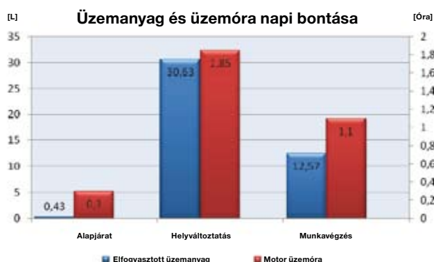
7. ábra: példa a fogyasztás és az üzemóra tevékenység szerinti bontására
