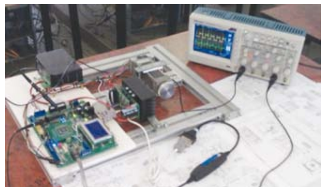
PMS-motor meghajtó fejlesztő rendszer mérése és programozása (Ladányi János)
