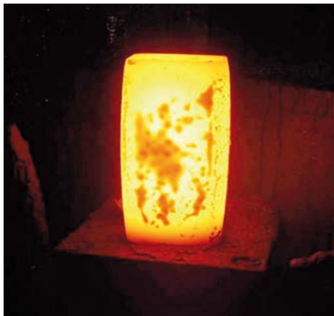
10. ábra: a kísérleti gyártás során zömített munkadarab képe
