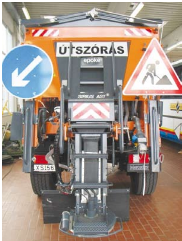
3. ábra: a felszerelt EPOKE sósórzó adapter
