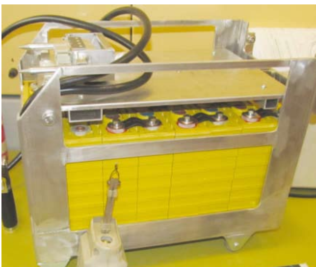
☐ 50 V névleges feszültségű lítium-akkumulátoros tápegység cserélhető kocsija
