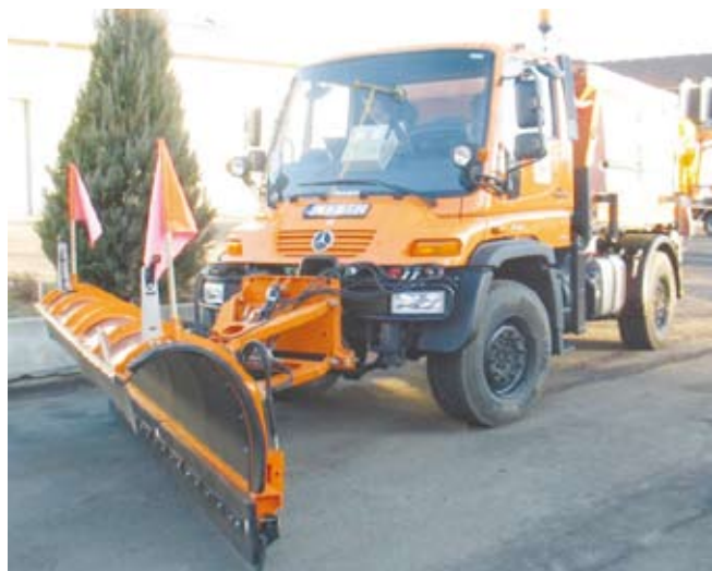
1. ábra: MB Unimog U400 eszközhordozó az adapterekkel
