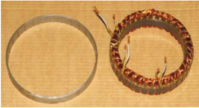
Fejlesztett külső forgórészes PMS-motor álló- és forgórésze
