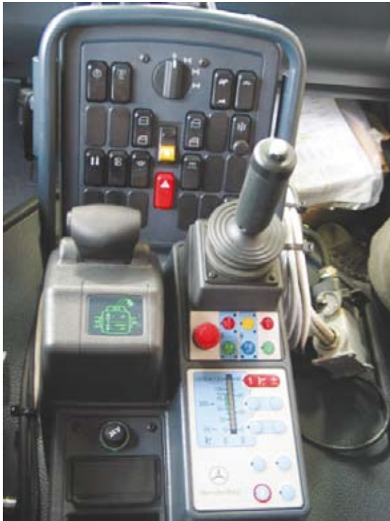
2. ábra: a hőkezelést biztosító hidraulika-vezérlőpult
