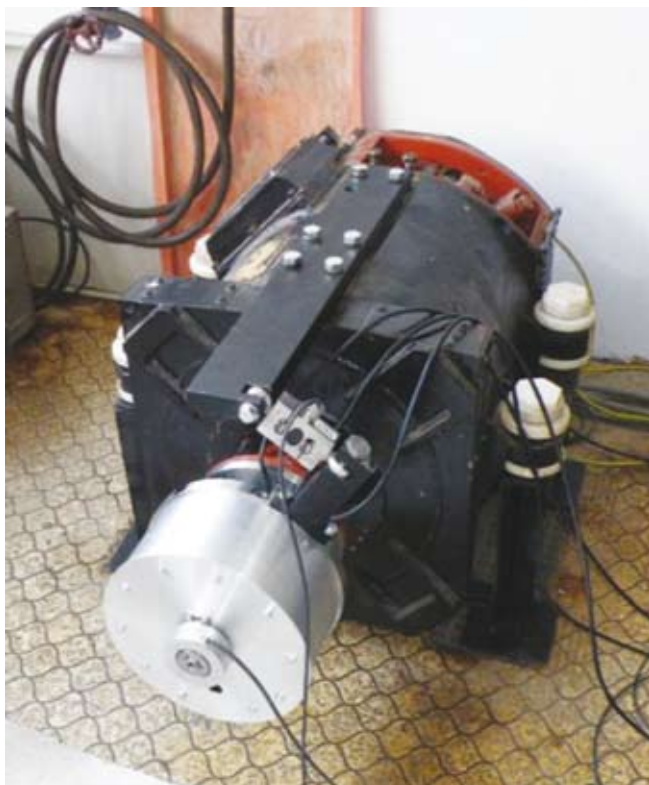
Referenciamotor mérése a nagymotorpróbpadon
