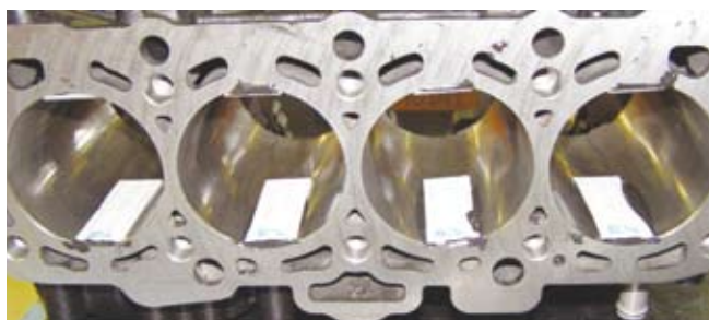
1. ábra: szilikonlenyomat készítése a hengerfelületről
