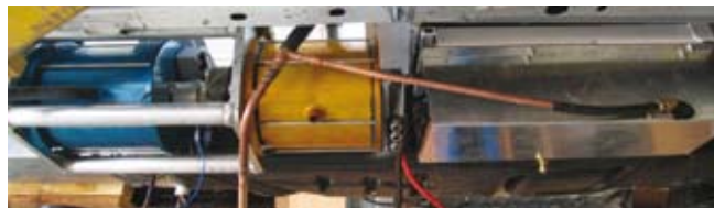
A fejlesztett motorok beépítése járműbe, a hűtőrendszer bekötése
