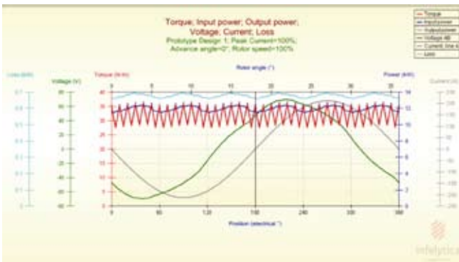
A lüktető nyomaték vizsgálata célszoftverrel (dr. Szénásy István, Infolytica)
