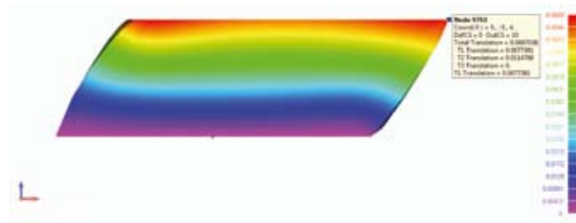
3. b ábra: a felső lapján, azzal párhuzamosan terhelt hasáb x-irányú (piros nyíl) elmozdulásai [mm] (Forrás: saját szerkesztés)
