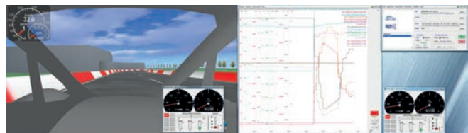
7. ábra: Kijelző tesztelése IPG CarMaker szimulációs környezetben
