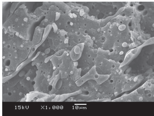
6. ábra: blende töretfelületéről készült pásztázó elektronmikroszkópos (SEM) felvételek. (a) HDPE / PA6 75/25; (b) HDPE/PA6 +1% PEGMA + 3% MMT
