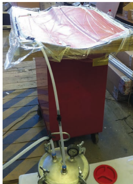
20. ábra: a vákuum alatt tartott elem, a kép előterében a gyantacsapda látható
