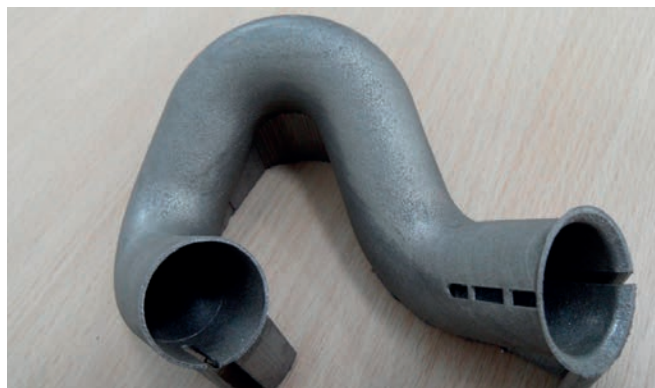
6. ábra: lézeres szinterezéssel előállított csőalkatrész
