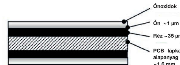
2. ábra: nyomtatott áramkört lapka keresztmetszeti rajza [8]
