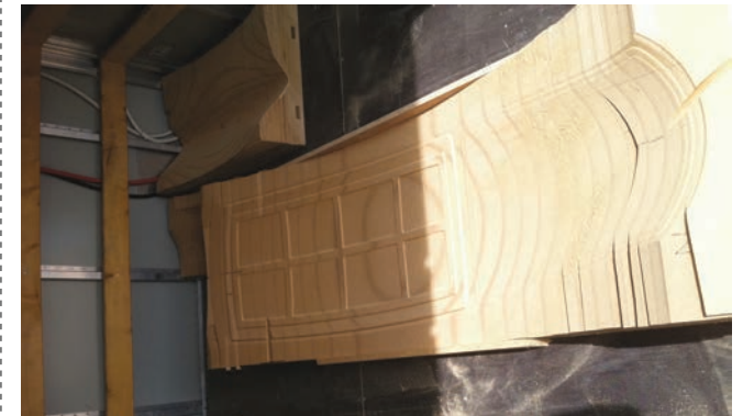
8. ábra: tetőszerszám marás közben
