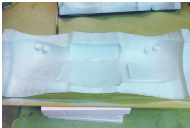
12. b. ábra: orrszerszám lakkozás előtt
