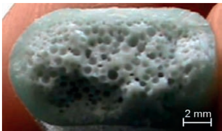
2. ábra: a darab töretfelülete
