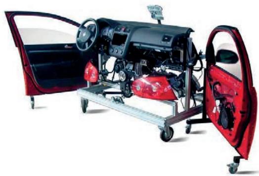
B. Tanfolyami műszerfal modell, működő elektronikus egységekkel
