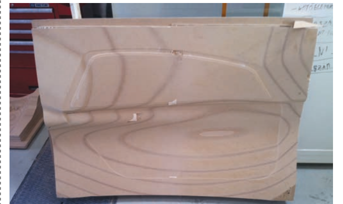
9. ábra: felületi hibák az ajtó kiforgácsoló szerszámán
