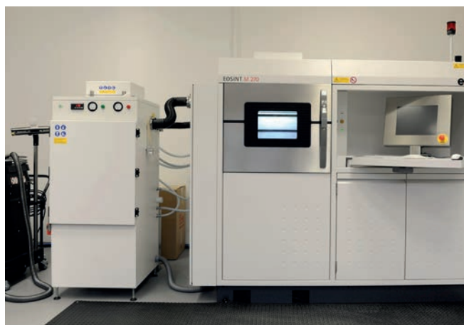
1. ábra: a Széchenyi István Egyetem Anyagtudományi és Technológiai Tanszékén üzemelő lézeres szinterezőberendezés
