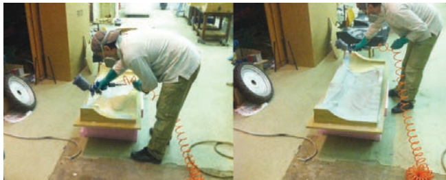
11. ábra: a kittréteg felvitele
