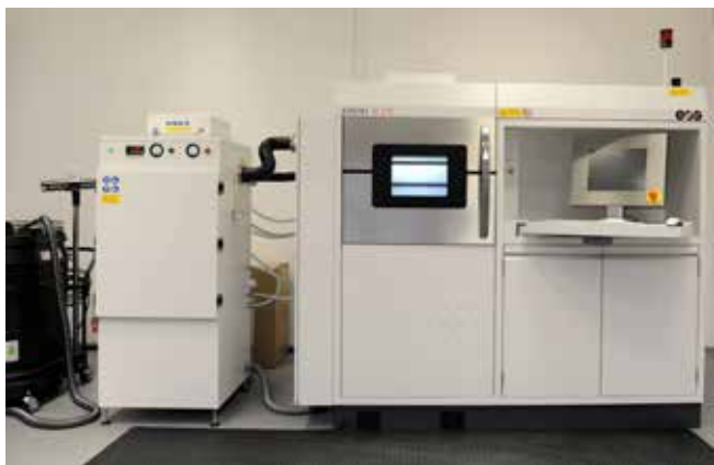
5. ábra: A Széchenyi István Egyetem Anyagtudományi és Technológiai Tanszékén üzemelő lézerszinterező berendezés
