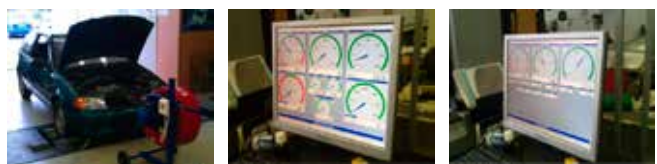
10. ábra: jármű a görgős padon, mérés közben
