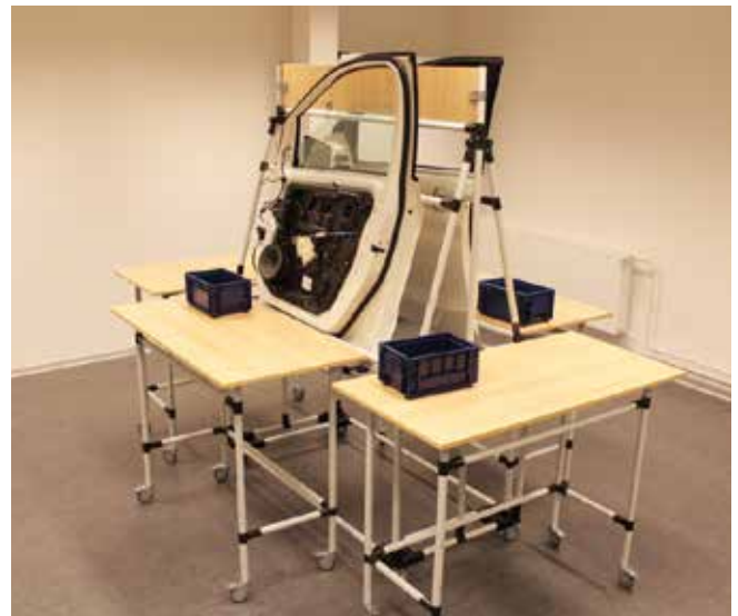
2. ábra: ajtó előszerelő állomás
