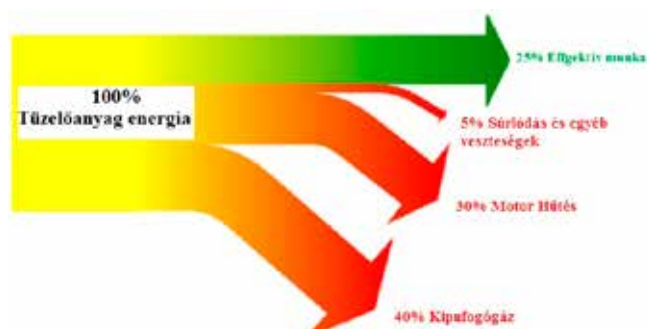
1. ábra: egy belső égésű motor veszteségeinek Sankey-diagramja [2]
