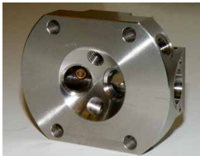
4.2. ábra: az Mm-IV motor hengerfeje
