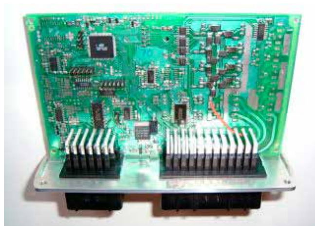
6.2. ábra: a VEMS motorvezérlő ECU, 2011
