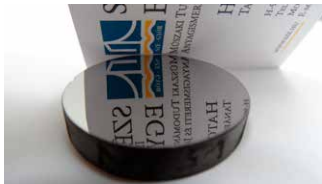
6. ábra: lézerszinterezett szerszámacél felülete polírozás után
