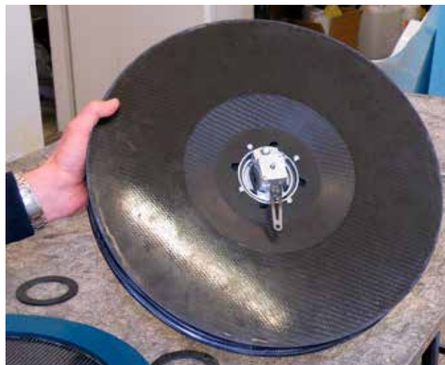
5.1. ábra: szénszál keréktárcsa
