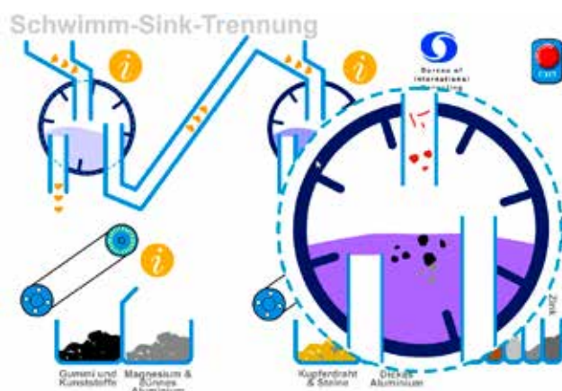
10. ábra: fajsúlykülönbségen alapuló szétválasztó berendezés flotálólvi vázlata
