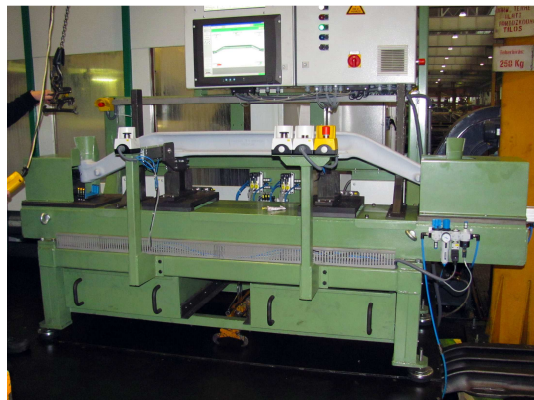
Megmunkált mellsőtengely mérő készülék
