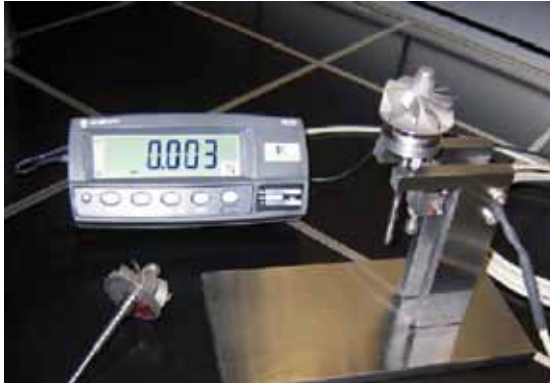
Turbinakerék statikus kiegyensúlyozatlanságát mérő berendezés (BWT)
