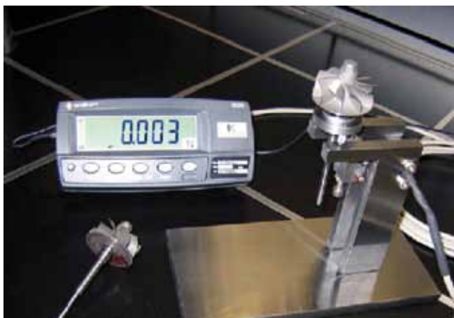
Turbinakerék statikus kiegyensúlyozatlanságát mérő berendezés (BWT)
