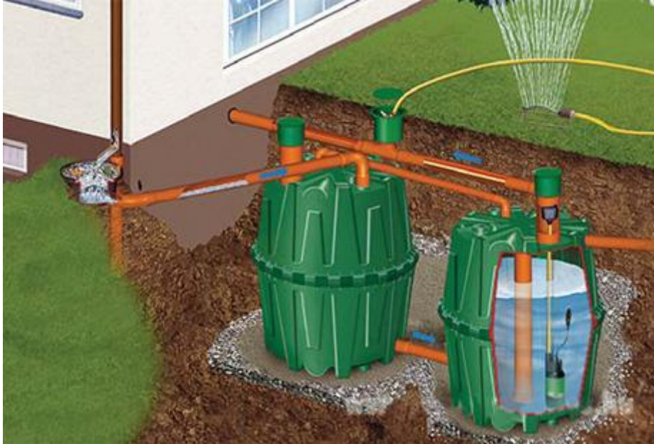
7. ábra: Öntözéshez: A sorba köthető tartályok ugyan plusz földmunkával járnak, de később is bővíthetők.
