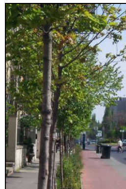
8. ábra: Új építésű gyűjtőút. gyalogosokat védi a zöldsáv, a szegély mellett nincs parkoló, nincs áttaposás. A zöldfelület ép marad. (Győr, Tihanyi Á. utca)
