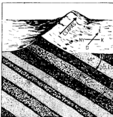
4.9. ábra A dőlés és a csapás értelmezése
