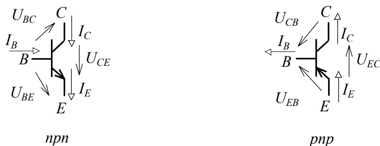
2.13. ábra. Az npn és a pnp típusú tranzisztor feszültség- és áramirányai közös emitterű kapcsolásban
