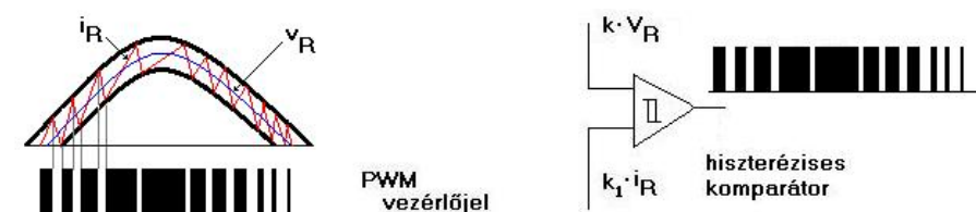
4.54. ábra. Az egyfázisú kétállásos (bang-bang) vezérlés alapelve
