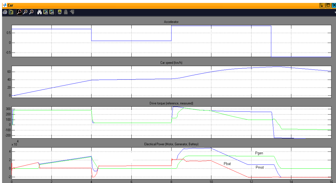
8. ábra. A gázpedálhelyzet, a járműsebesség, a hajtás kimenőnyomatékának alapjele és mért értéke, valamint a villamos teljesítmények – P_{\text{generátor}} , P_{\text{motor}} és P_{\text{battery}} - időfüggvény ábrái az első 16 s alatt
