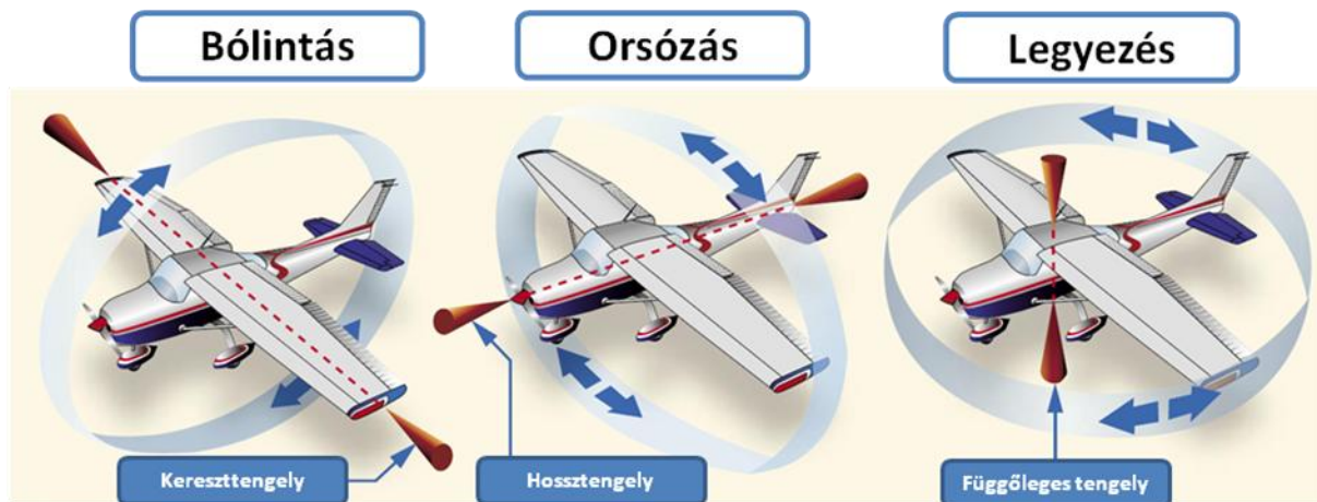
207. ábra Repülőgép tengelyei és térbeli mozgásai
