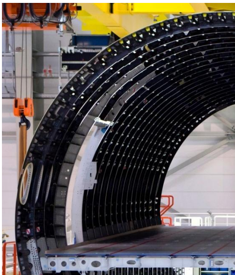
210. ábra Az Airbus A350 XWB kompozit törzsszekció
