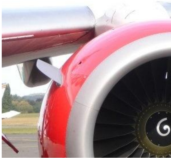
179. ábra: Terelőlemez a szárny és a hajtómű-gondola közötti interferencia ellenállás csökkentésére
