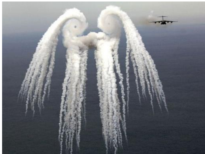
181. ábra A szárnyvégen keletkező örvény mérete
