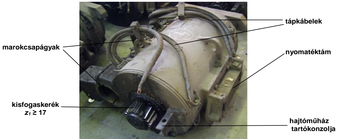
61. ábra A járműből kiserelt marokcsapágyas villamos vontatómotor
