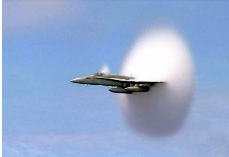
180. ábra Lökéshullám miatt kicsapódó pára
