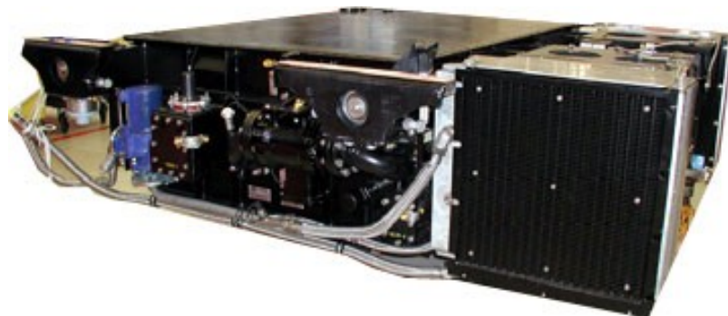
46. ábra: Transzformátor a Power-Pack-hűtővel
