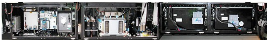
52. ábra: Segédüzemi energiaellátás (BNV-blokk)
