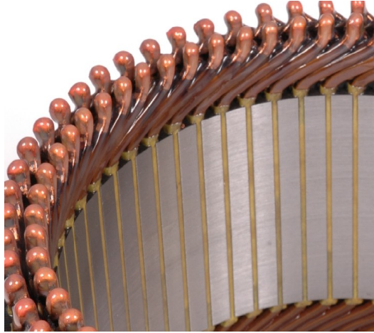
2. ábra. Menetenként egy tömör rúddal készült hurkos tekercselés, a rudak meghajlított és egymás mellé illesztett végeinek hegesztésével
