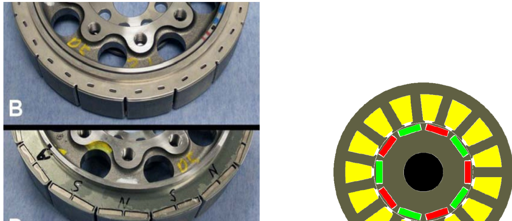
5. ábra. Besüllyesztett („burried”) elnevezésű mágnes-elhelyezés.
