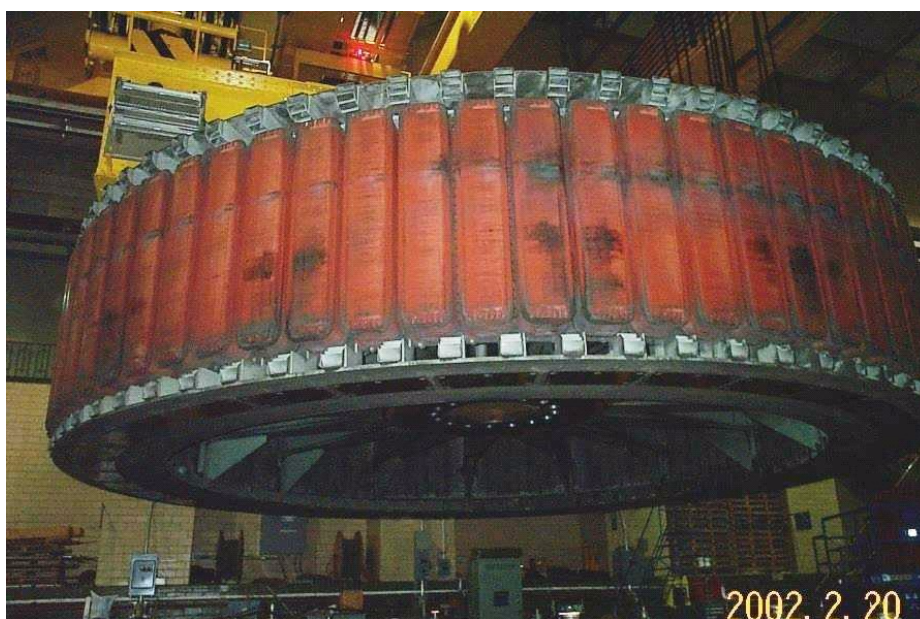
Függőleges tengelyű kiálló pólusú hidrogenerátor forgórésze
