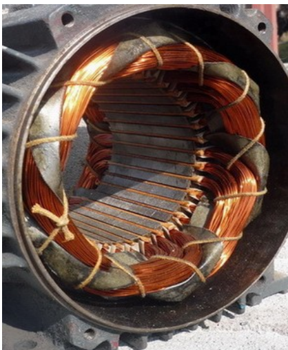
1. ábra. Megbontott, kalickás forgórészű aszinkron motor álló- és forgórésze képei
