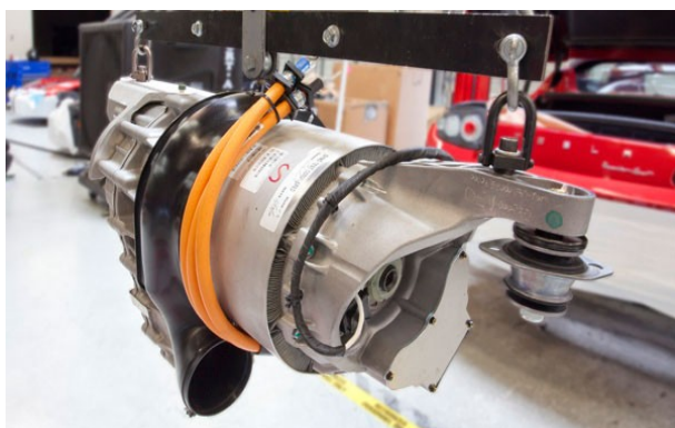
14. ábra. A TESLA aszinkron motorja és hajtáselrendezése
