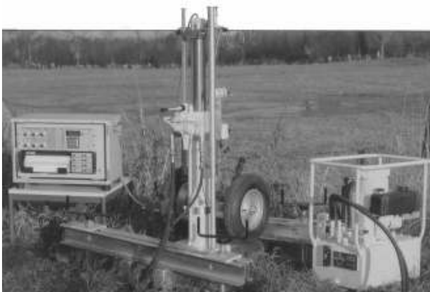
12.12. ábra. Statikus szonda
