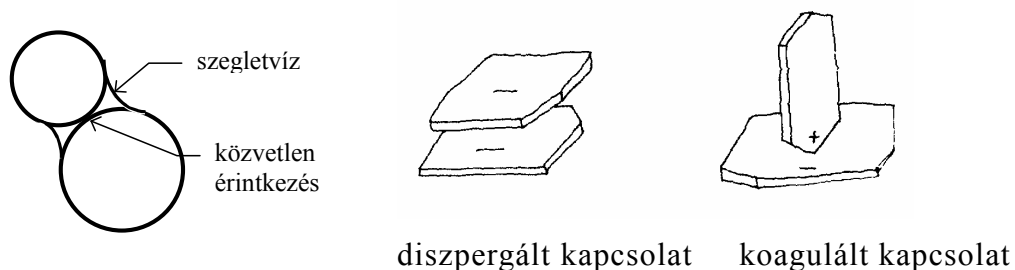
2.4. ábra. A homok- illetve az agyagszemcsék kapcsolata.
